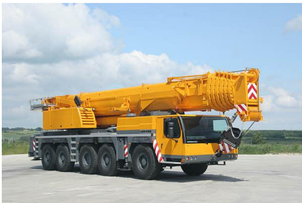
Liebherr mobilna dizalica LTM 1200-5.1, 200- tonska dizalica.
