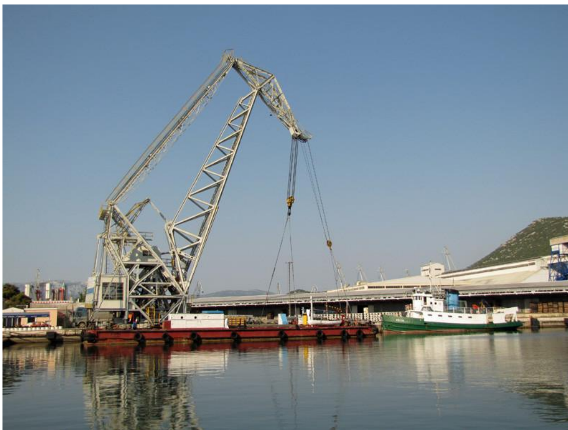
Plovna dizalica "Brina", nosivost 100 t
