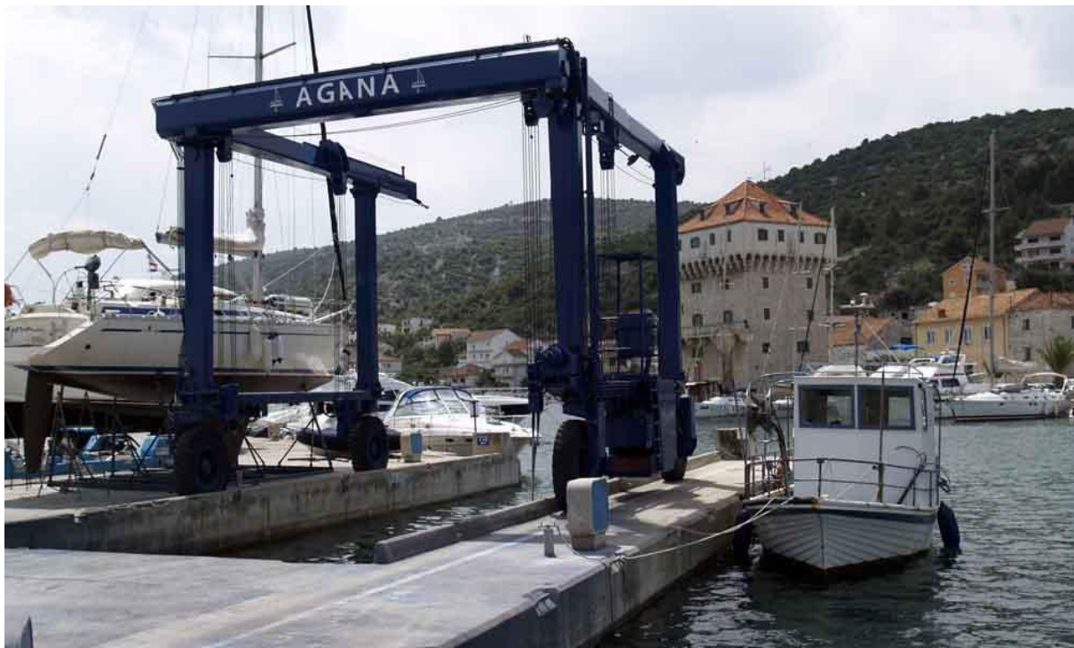
Portalna dizalica dužine okvira 6m, nosivosti 60 tona
