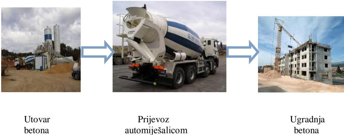
Slika 4.2. Shema korištenja strojeva za betonske radove
