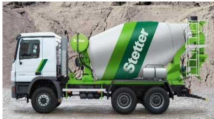
Slika 2.6. Automješalica Stetter F4L914
