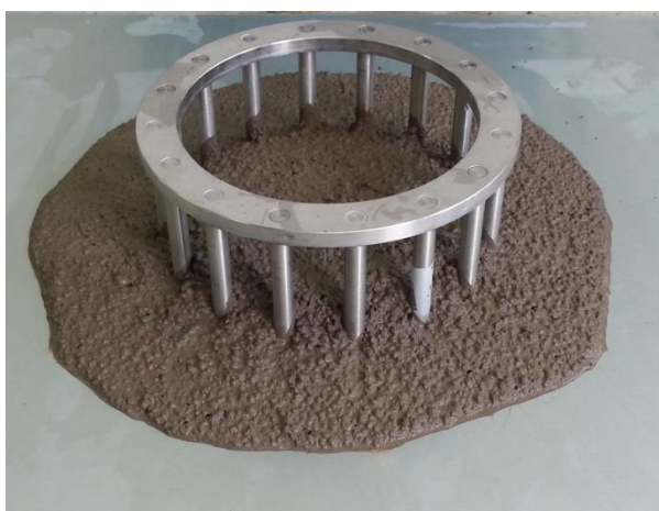
Slika 5.5. Ispitivanje J-prstenom [slika zabilježena tijekom ispitivanja]
