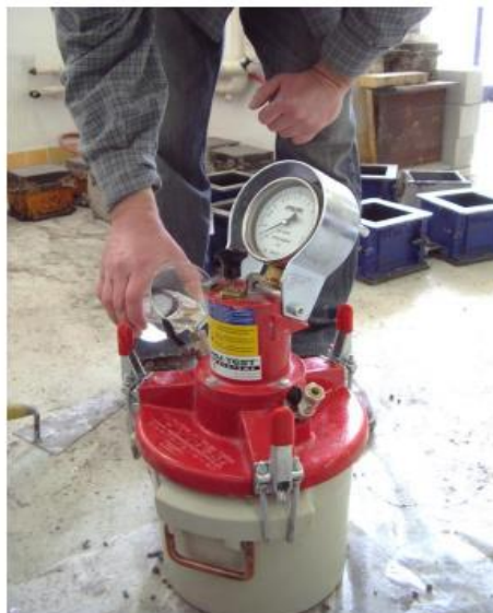
Slika 5.7. Ispitivanje sadržaja zraka u svježem betonu pomoću porometra [4]
