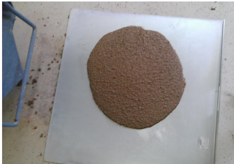
Slika 5.3. Razastiranje betona [slika zabilježena tijekom ispitivanja]
