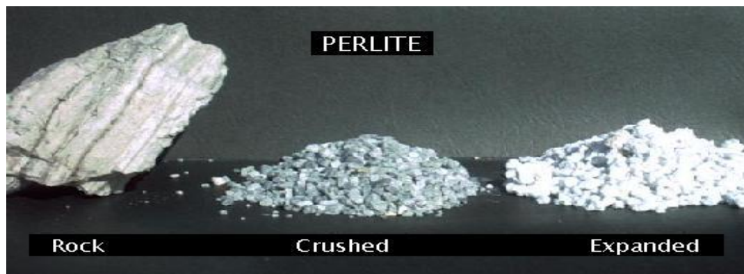
Slika 2.4. Izgled perlita u procesima obrade [9]
