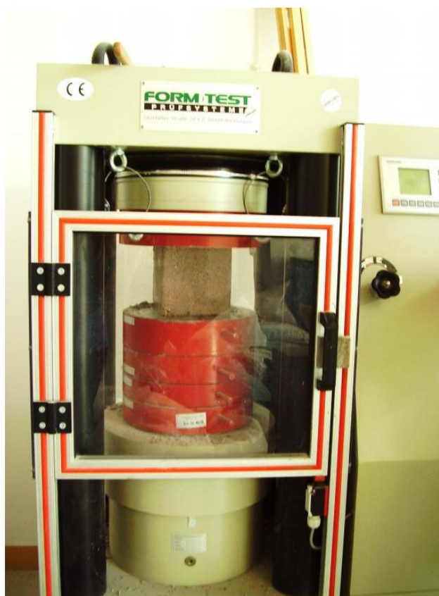
Slika 4.8. Ispitivanje tlačne čvrstoće [4]
