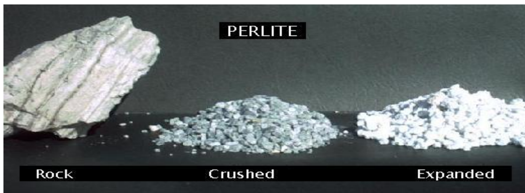
Slika 2.4. Izgled perlita u procesima obrade [9]
