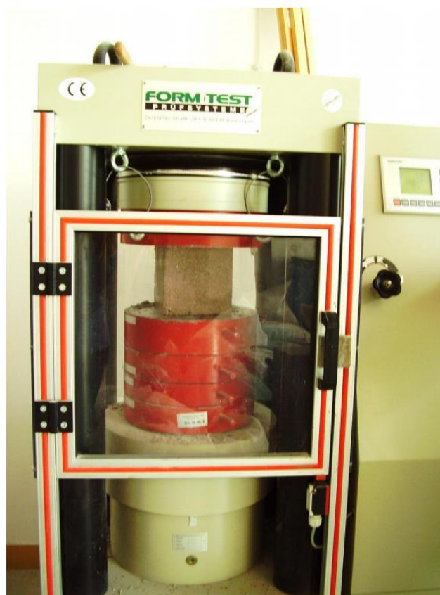
Slika 4.8. Ispitivanje tlačne čvrstoće [4]
