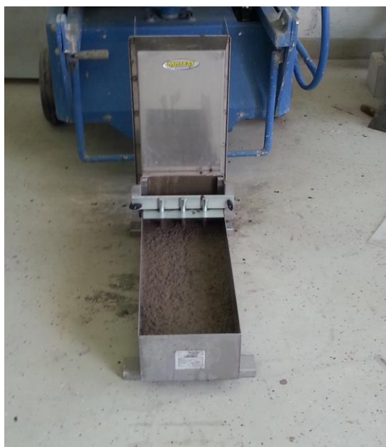
Slika 4.4. L- box uređaj [slika zabilježena tijekom ispitivanja]
