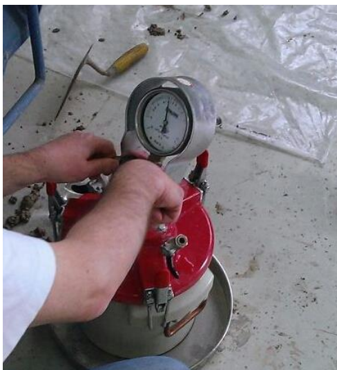
Slika 4.7. Ispitivanje sadržaja zraka u svježem betonu pomoću porometra [slika zabilježena tijekom ispitivanja]
