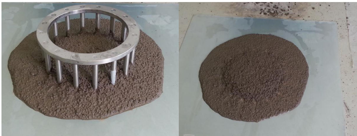
Slika 4.5. Ispitivanje J- prstenom [slika zabilježena tijekom ispitivanja]
