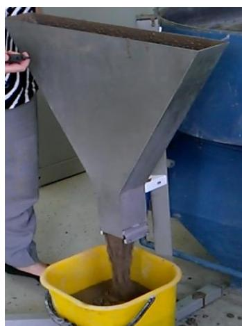
*Slika 4.1. V-lijevak [slika zabilježena tijekom ispitivanja]*
