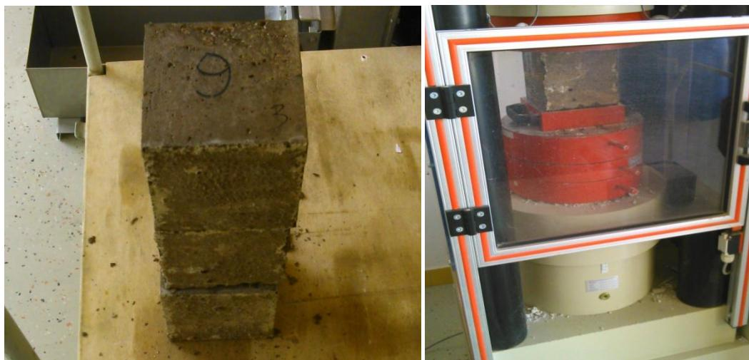
**Slika 4.12.** Uzorci, preša za ispitivanje čvrstoće [slika zabilježena tijekom ispitivanja]
