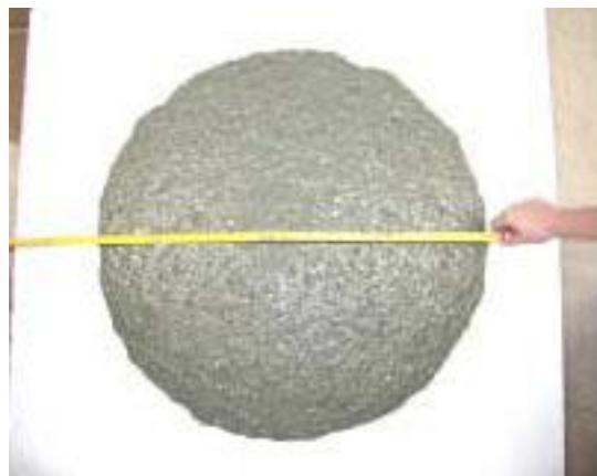
Slika 4.2. Metoda razastiranja (Slump-flow) [5]
