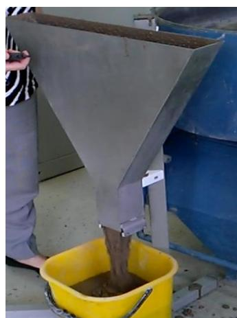
*Slika 4.7. Ispitivanje V-lijevkom [slika zabilježena tijekom ispitivanja]*
