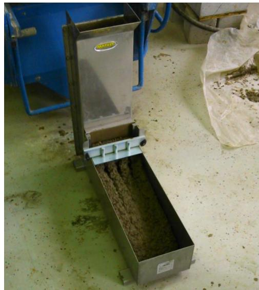
*Slika 4.9. L-box [slika zabilježena tijekom ispitivanja]*
