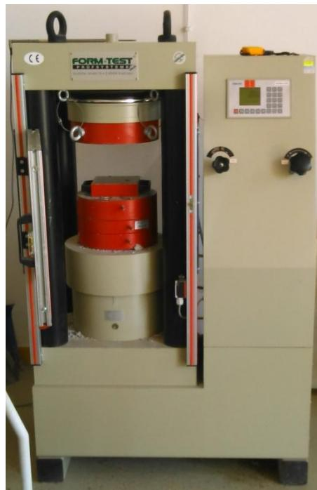
*Slika 4.6. Preša za ispitivanje čvrstoće na pritisak*
