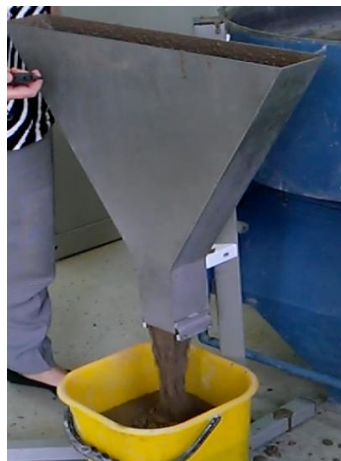
Slika 4.7. Ispitivanje V-lijevkom [slika zabilježena tijekom ispitivanja]
