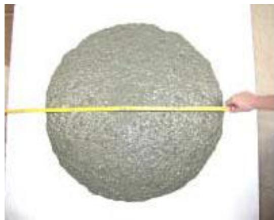
*Slika 4.8. Rezultati metode razastiranja (Slump-flow) [5]*
