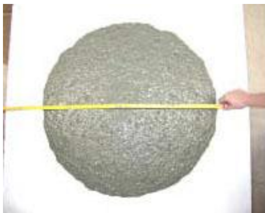
Slika 4.8. Rezultati metode razastiranja (Slump-flow) [5]
