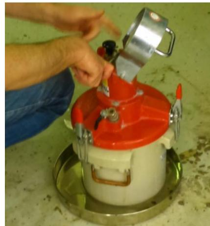
*Slika 4.11. Ispitivanje pomoću porometra [slika zabilježena tijekom ispitivanja]*
