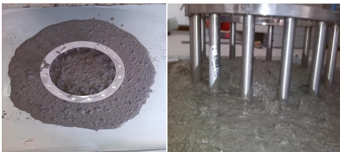
Slika 4.27 Rezultati ispitivanja J-prstenom mješavine SCC4
