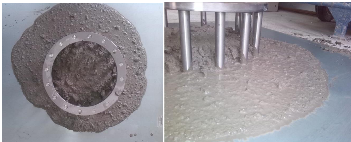
Slika 4.30 Rezultati ispitivanja J-prstenom mješavine SCC7
