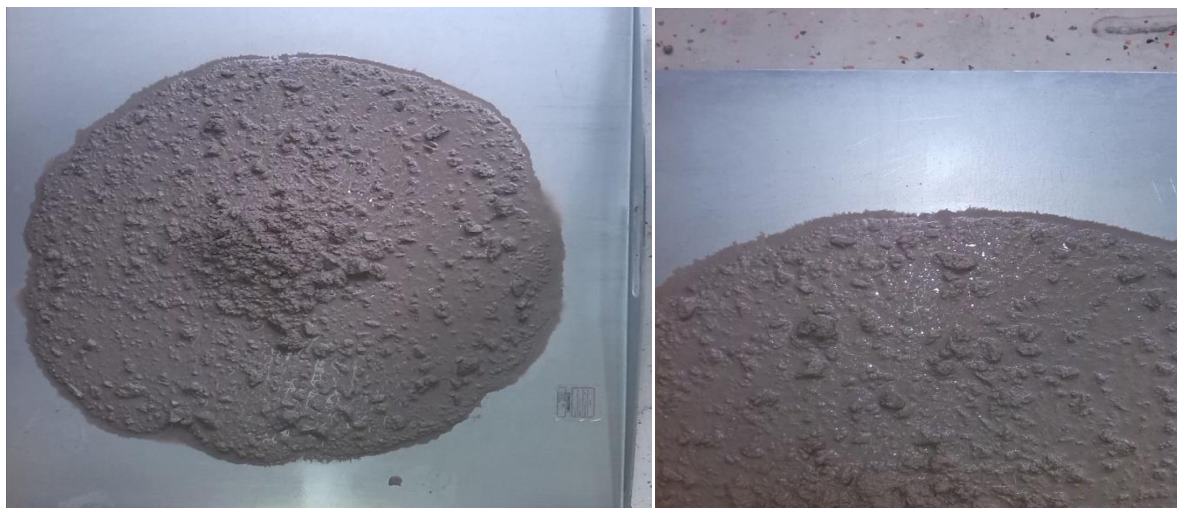
Slika 4.12 Rasprostiranje-slijeganjem mješavina SCC7
