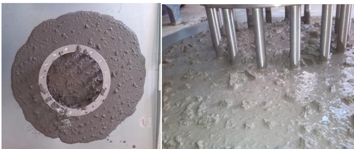
Slika 4.29 Rezultati ispitivanja J-prstenom mješavine SCC6
