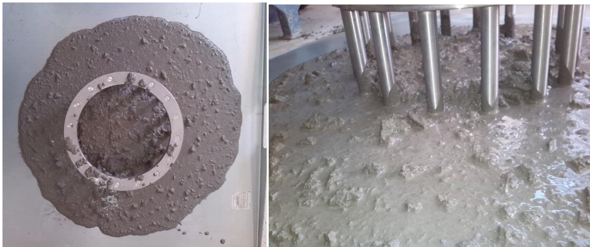
Slika 4.29 Rezultati ispitivanja J-prstenom mješavine SCC6
