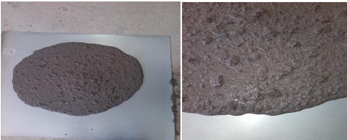
Slika 4.9 Rasprostiranje-slijeganjem mješavina SCC4
