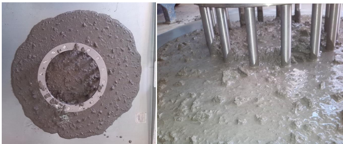
Slika 4.29 Rezultati ispitivanja J-prstenom mješavine SCC6
