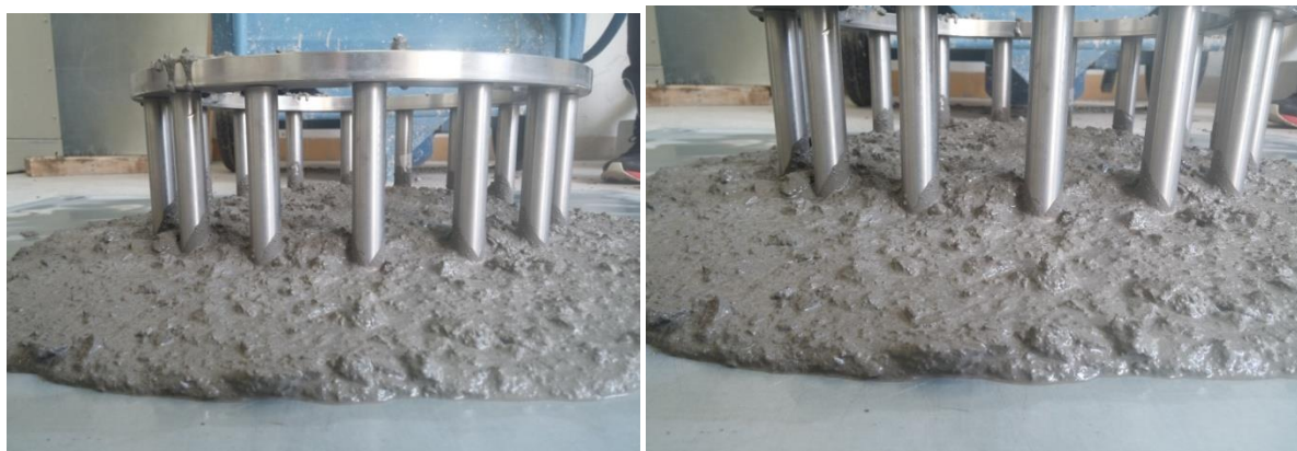
Slika 4.26 Rezultati ispitivanja J-prstenom mješavine SCC3
