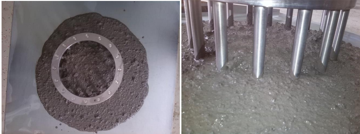
Slika 4.28 Rezultati ispitivanja J-prstenom mješavine SCC5
