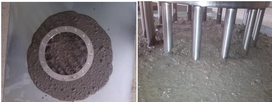
Slika 4.28 Rezultati ispitivanja J-prstenom mješavine SCC5
