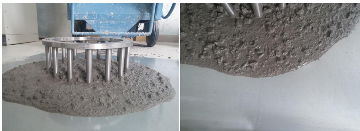
Slika 4.25 Rezultati ispitivanja J-prstenom mješavine SCC2
