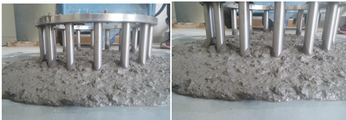
Slika 4.26 Rezultati ispitivanja J-prstenom mješavine SCC3
