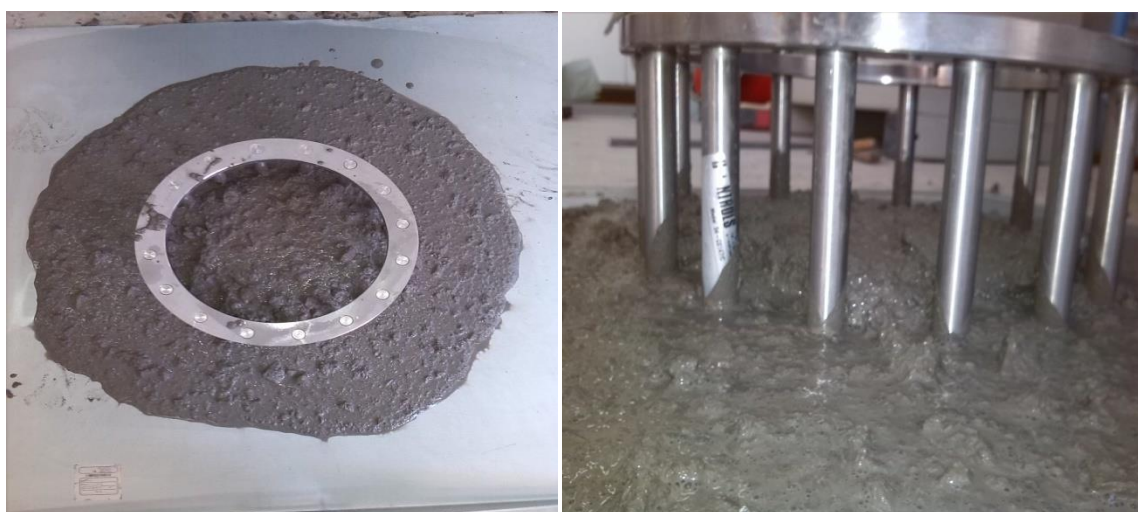
Slika 4.27 Rezultati ispitivanja J-prstenom mješavine SCC4
