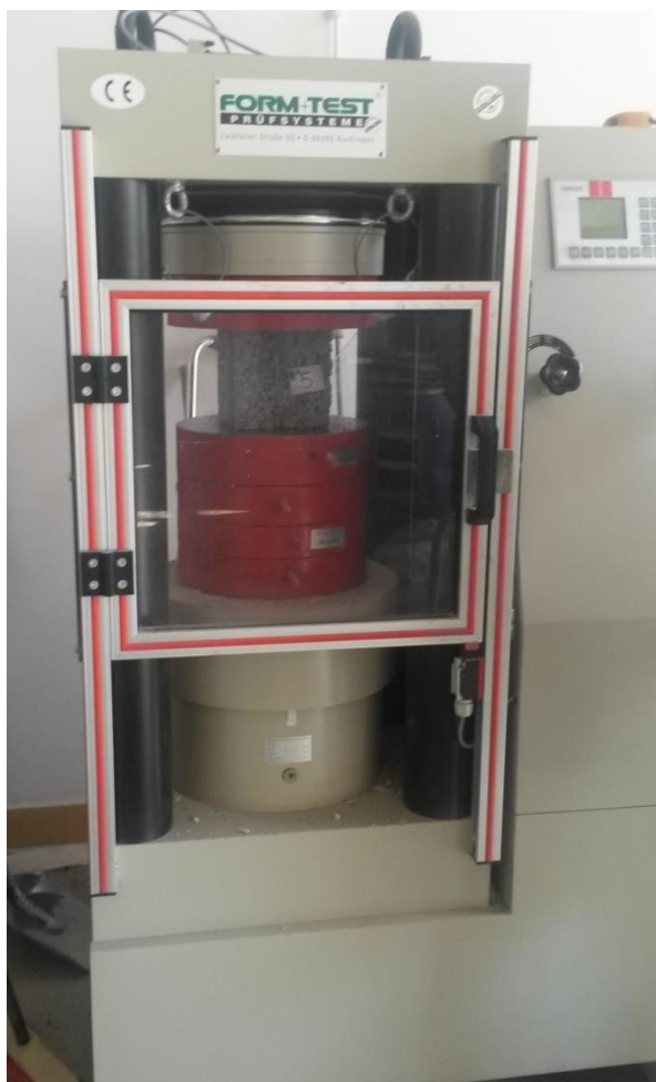
Slika 5.5 Preša za mjerenje tlačne čvrstoće
