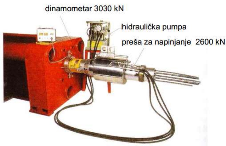
Slika 3.17 Kontrola rada preše na ispitnom užetu [9]
