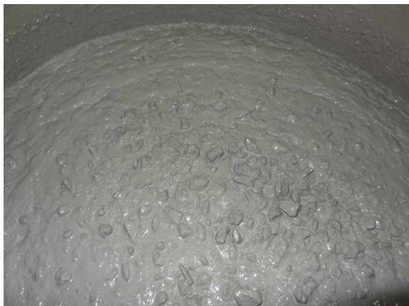
Slika 6.13.: Zgušnjavanje mješavine M3 - tiksotropija
