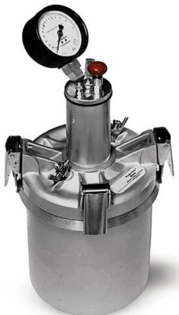
Slika 4.5.: Uređaj za ispitivanje sadržaja pora u svježem betonu [18]
