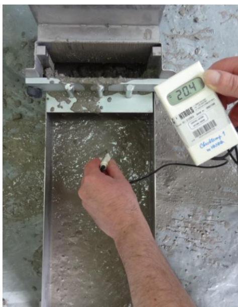
Slika 6.22.: Mjerenje temperature svježe mješavine (M8)
