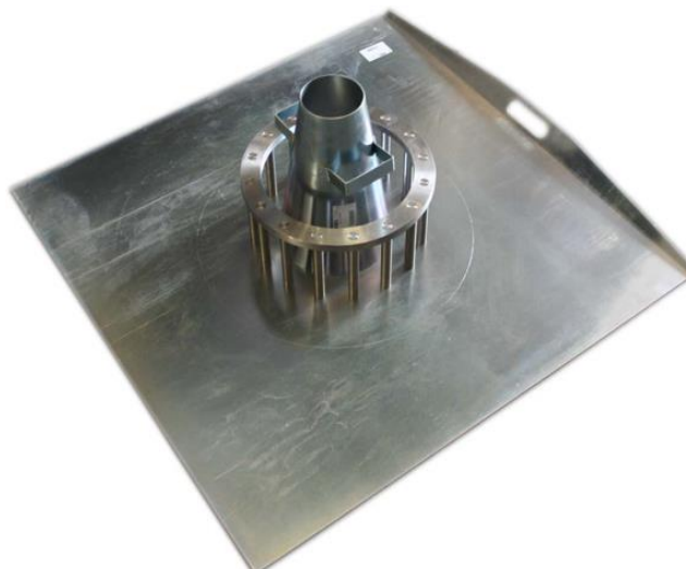
Slika 4.3.: Oprema za ispitivanje J- prstenom[17]
