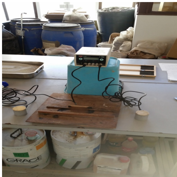
Slika 5.6 Uređaj za mjerenje ultrazvučnih valova
