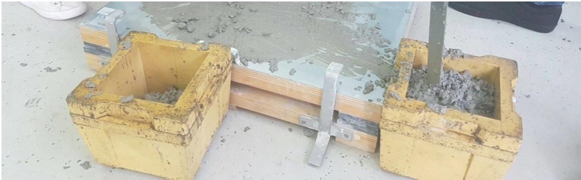
Slika 23. Kalupi za svježi beton
