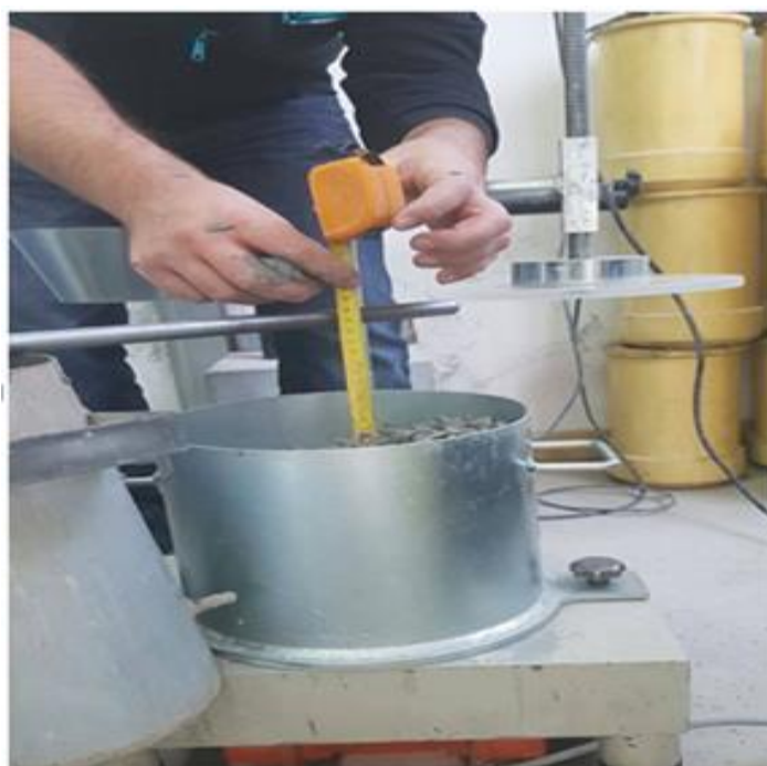
Slika 21. Mjerenje konzistencije Vebe metodom
