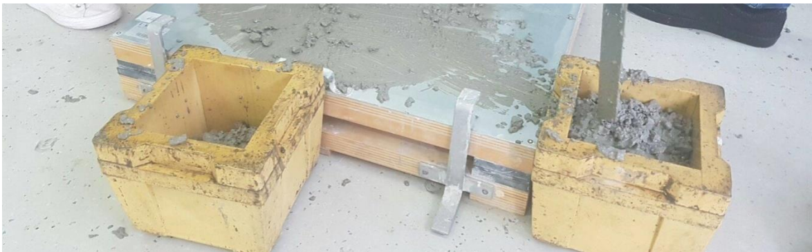
Slika 23. Kalupi za svježi beton
