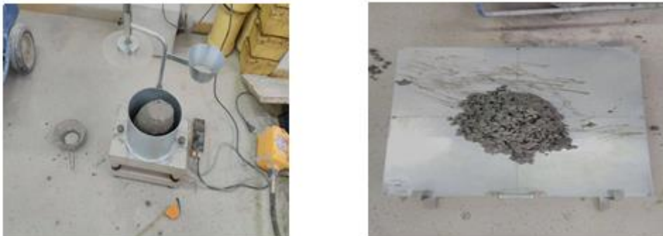
Slika 18. Rasprostiranje betona s dodatkom letećeg pepela [slike zabilježene tijekom ispitivanja]
