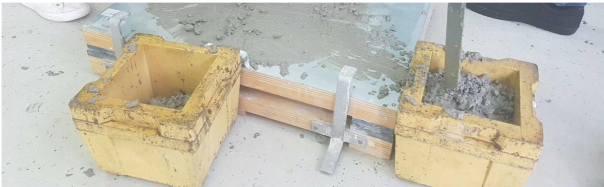
Slika 23. Kalupi za svježi beton
