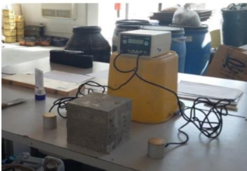
Slika 27. Ispitivanje ultrazvukom [slika zabilježena tijekom ispitivanja]
