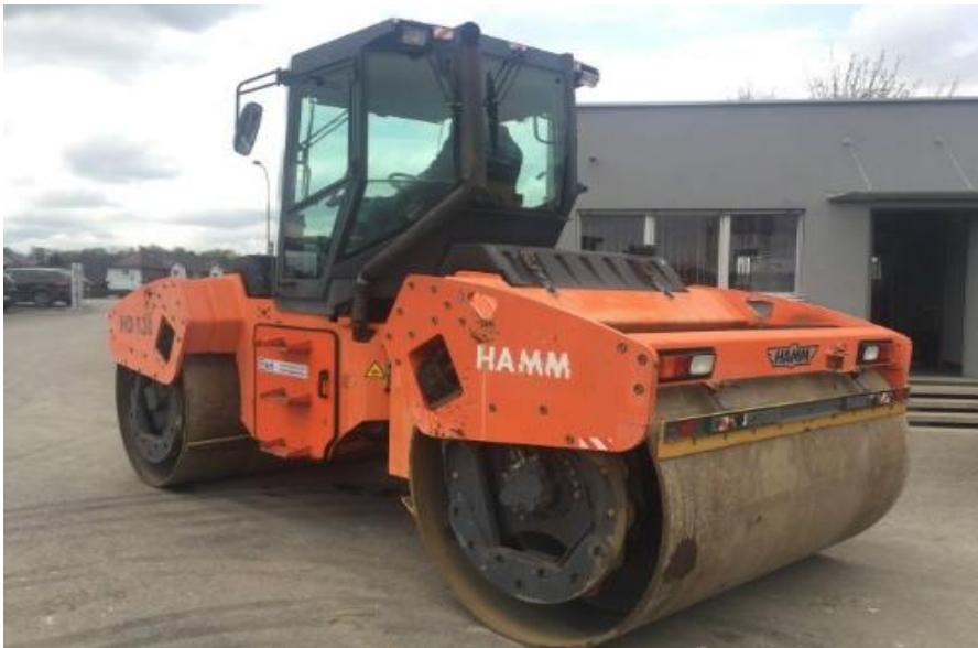
Slika 11- valjak Hamm HD 130 [10]
