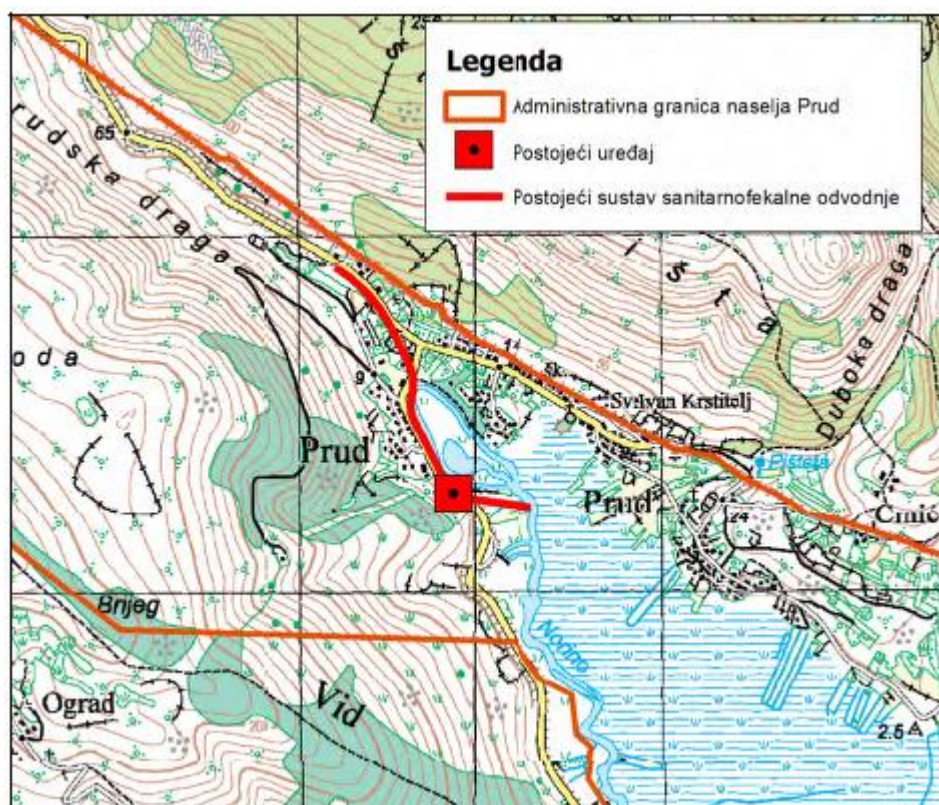
Slika 12.1.2. Prikaz postojećeg sustava odvodnje sanitarno fekalnih voda
