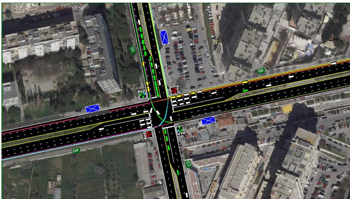
Slika 4.34. Prikaz problema na privozu Q1 (zelena vozila-lijevi skretači, bijela vozila- kretnja naprijed kroz raskrižje)
