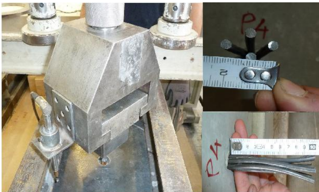
Slika 4.20 Zakretanje glave (lijevo); Izgled užeta nakon testa (desno)
