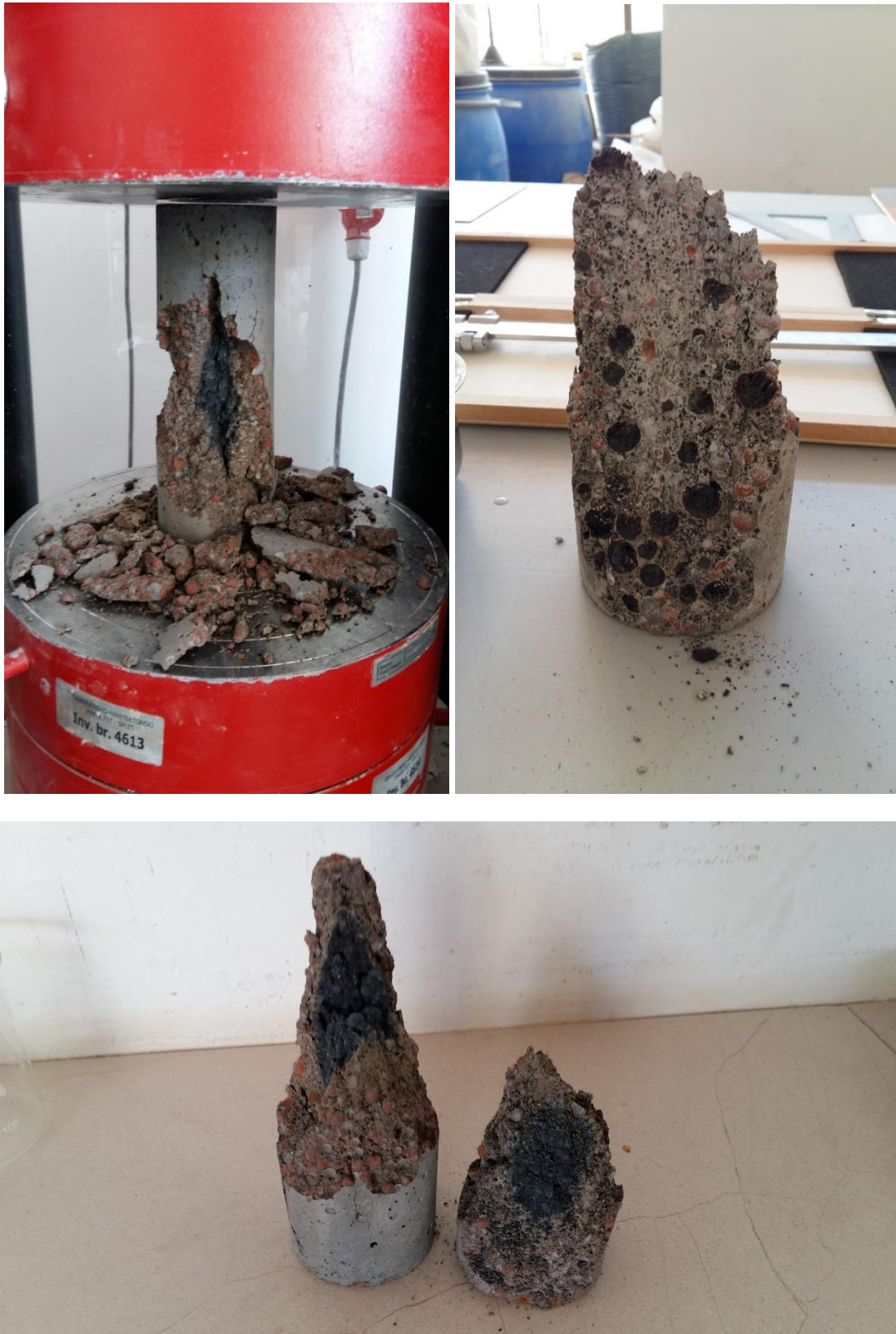
Slika 6.8. Ispitivanje tlačne čvrstoće uzoraka mješavine SCC7 [slike zabilježene tijekom ispitivanja]
