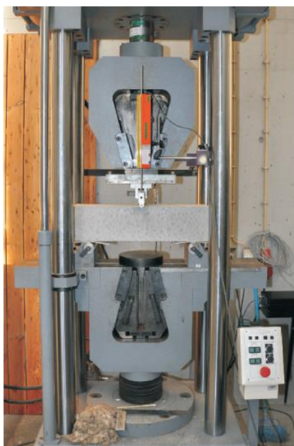
Slika 4.14. a) Uređaj za ispitivanje čvrstoće na savijanje; b) Uređaj za mjerenje modula elastičnosti [15]
