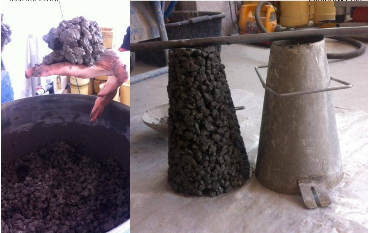
Slika 5.3 Ispitivanje konzistencije mješavine P 3
