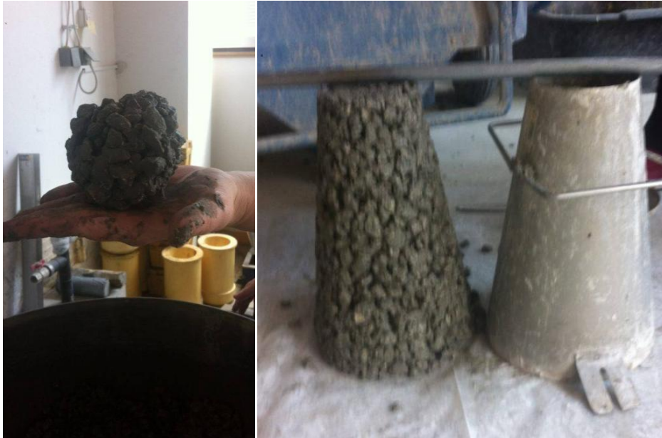
Slika 5.6 Ispitivanje konzistencije mješavine P_5 uz korekciju
