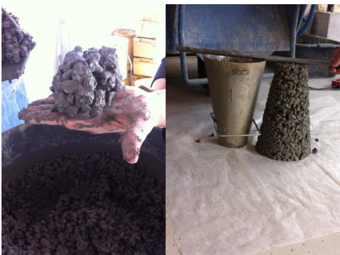
Slika 5.1 Ispitivanje konzistencije mješavine P_1
