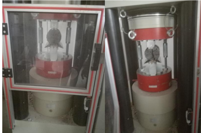
Slika 4.12 Preša za ispitivanje vlačne čvrstoće cijepanjem
