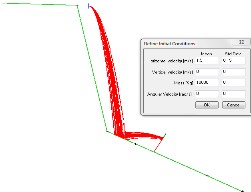
Slika 55. Prikaz barijere u RocFall-u i trajektorija gibanja
