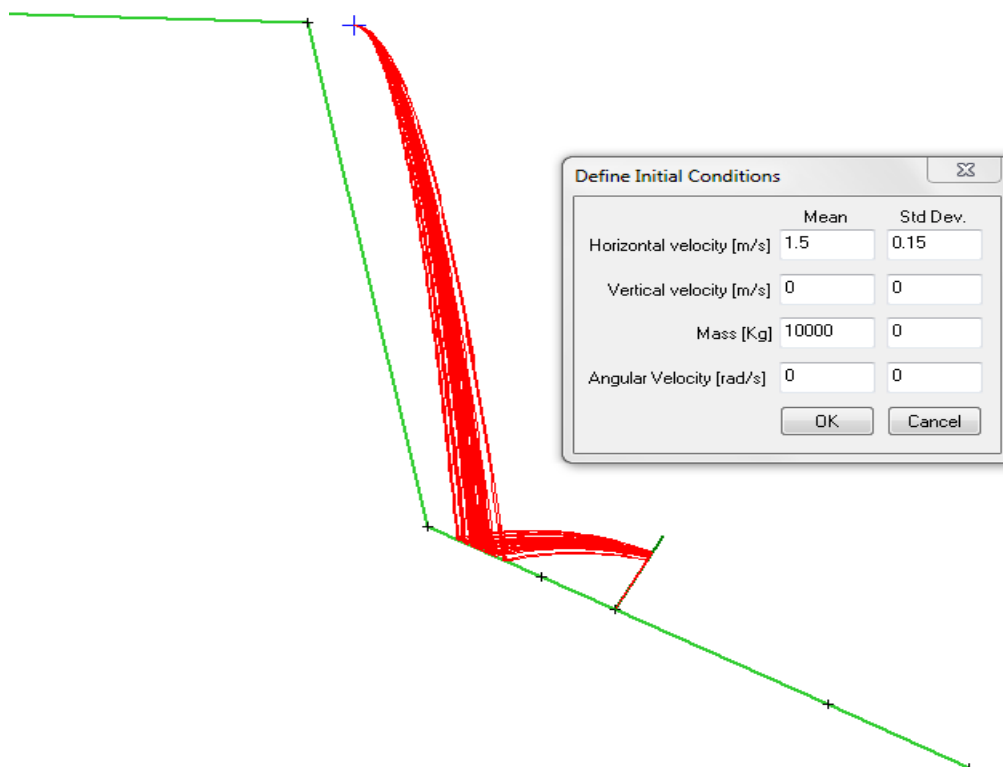
Slika 55. Prikaz barijere u RocFall-u i trajektorija gibanja
