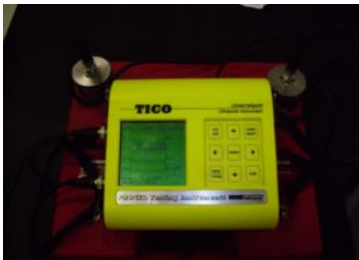
Slika 4.8.: Ultrazvučni uređaj TICO Proceq Testing Instruments [3]
