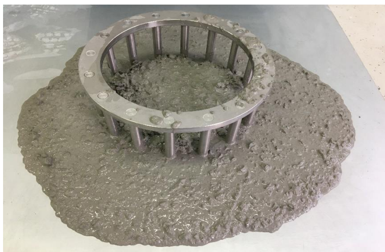
Slika 6.15.: Ispitivanje J-ringa (mješavina N8)
