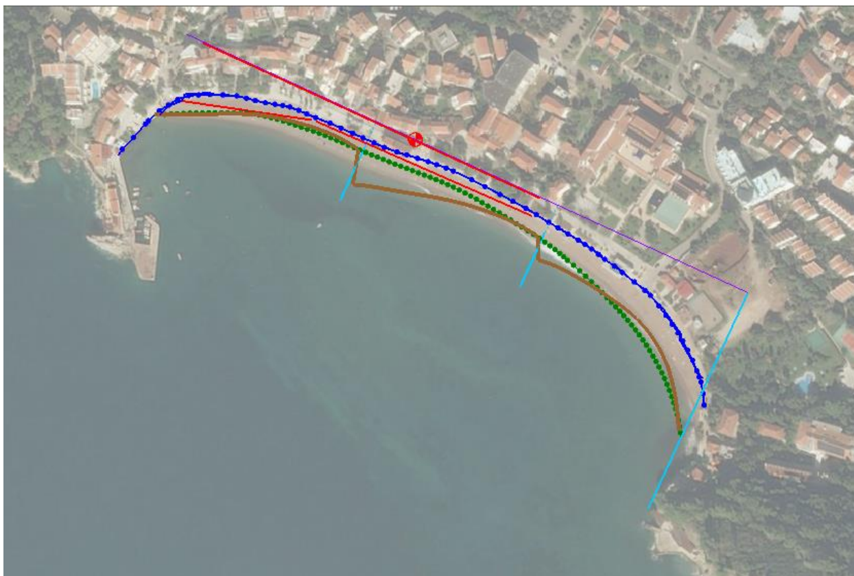
Slika 10.8 Rješenje s istočnim rubnim uvjetom - nepropusno pero 120 (m) i 5 (m) dubine
