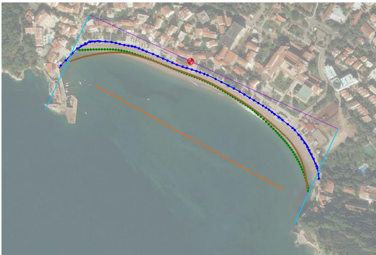
Slika 10.19 Prag širine 150 m sa gated nepropusnim rubnim uvjetima
