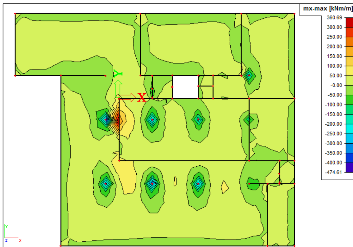
Slika 136. Dijagram momenta savijanja M_x (kNm/m')
