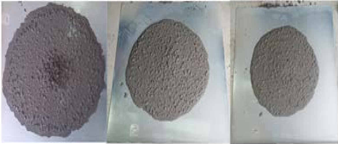
Slika 3.4. Mjerenje promjera razastiranja SCC1, SCC2, SCC3 [slika zabilježena tijekom ispitivanja].
