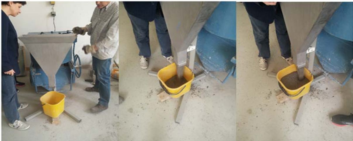
Slika 3.2. V- lijevak test (V- funnel) [slika zabilježena tijekom ispitivanja].
