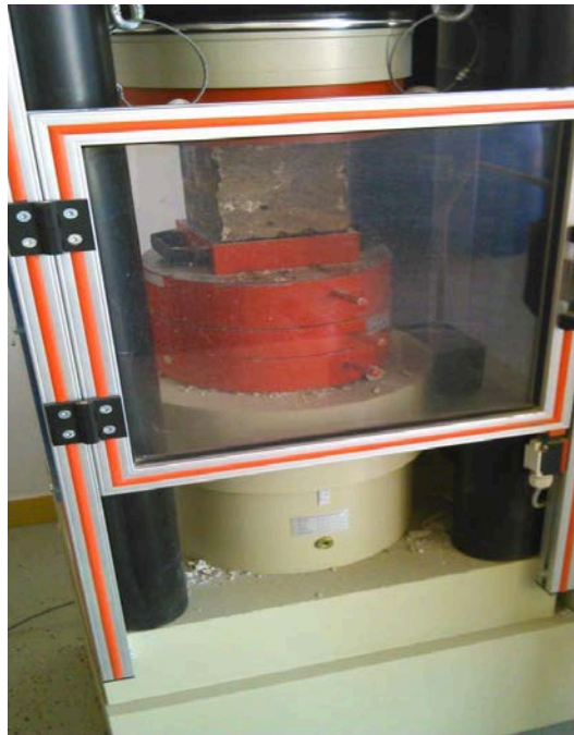
Slika 3.11. Ispitivanje tlačne čvrstoće [slika zabilježena tijekom ispitivanja].
