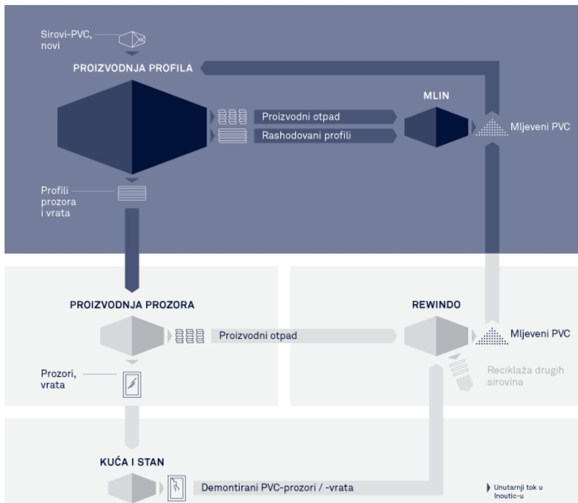
*Slika 2: Shematski prikaz PVC profila od recikliranih materijala*
