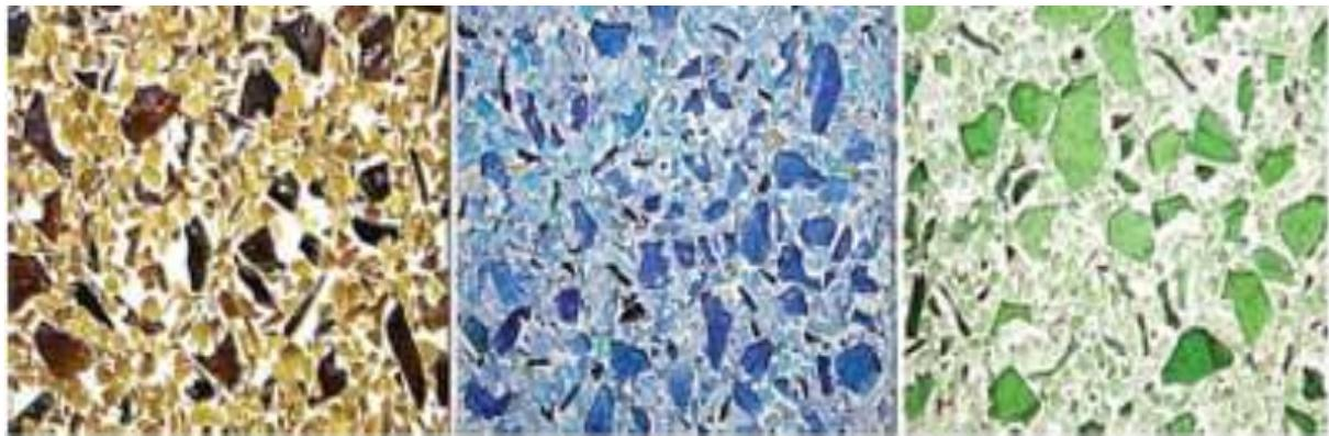
*Slika 1. Izgled betona sa različitim vrstama recikliranog stakla*
