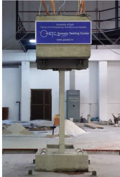
Slika 2.23. Fotografija karakterističnog stupa spremnog za ispitivanje
