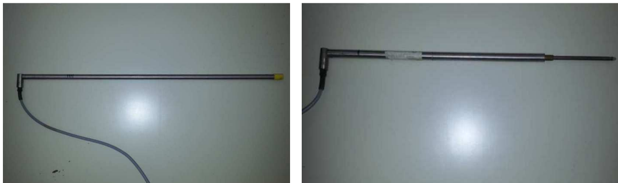
Slika 2.15. Senzori za mjerenje pomaka
