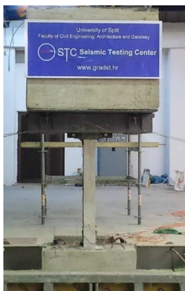
(i) Izgled karakterističnog stupa
