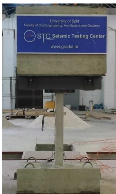
(i) Izgled karakterističnog stupa
