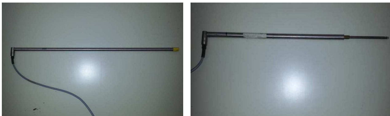
Slika 2.15. Senzori za mjerenje pomaka
