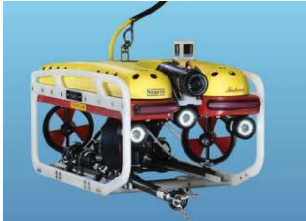
Slika 5.36 ROV ronilica SEAEYE FALCON korištena za profiliranje dna Crvenog jezera.
