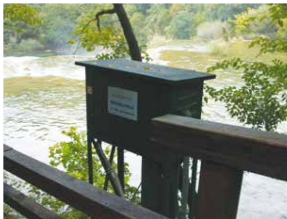
Slika 4: Limnigraf vodomjerne postaje Nacionalni park snimljen 6. listopada 2015. (snimila: T. Roje-Bonacci)
