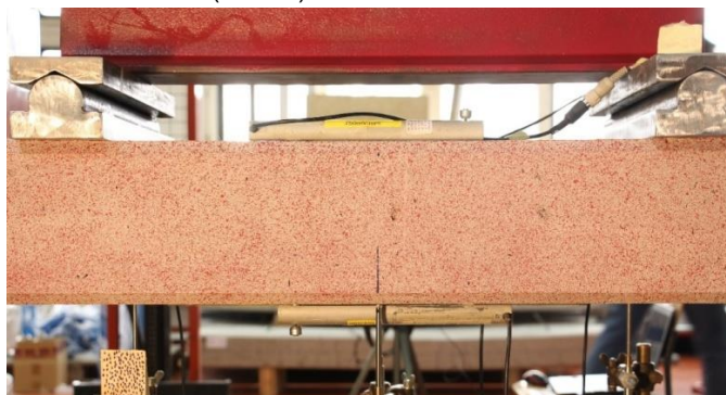
Slika 1. Površina uzorka pripremljena za digitalnu analizu slike
