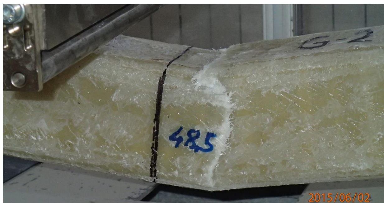
Fotografija 2.18 Prikaz pukotina
