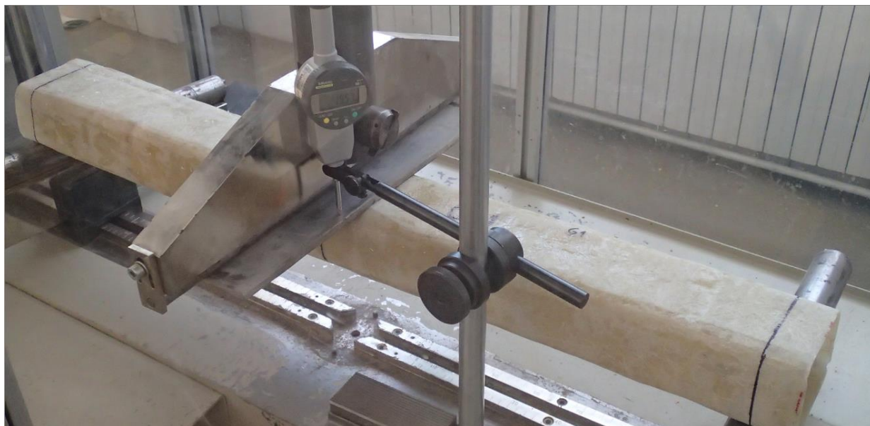
Fotografija 2.9 Postavljanje mikroure na mjerno mjesto
