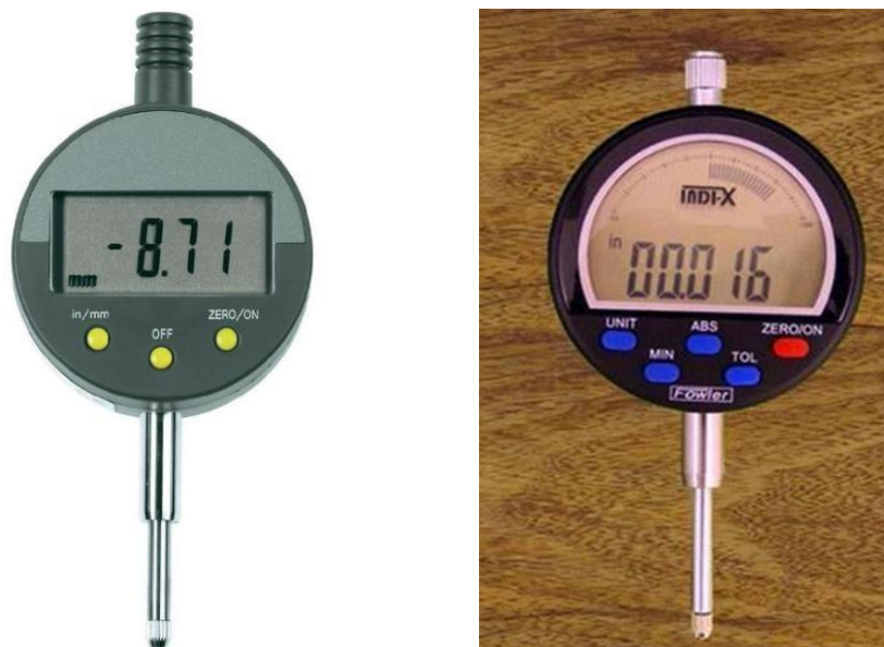
Fotografija 2.4 Mehanička mikroura s digitalnim očitavanjem
