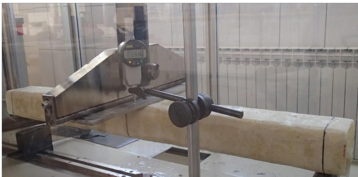
Fotografija 2.3 Prikaz postavljanja mikrouređaja na mjerno mjesto
