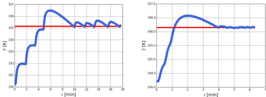
**Slika 3.** Primjer loše (lijevo) i dobre stabilizacije (desno) temperature u peći. Kod loše stabilizacije ciljana vrijednost temperature (335.15 K, crvena linija) postignuta je neodgovarajućim PID parametrima 1, 2.5, 1.25. Ciljana vrijednost (336.15 K) dobre stabilizacije postignuta je optimalnim PID parametrima prema pronađenoj empirijskoj relaciji (2).
