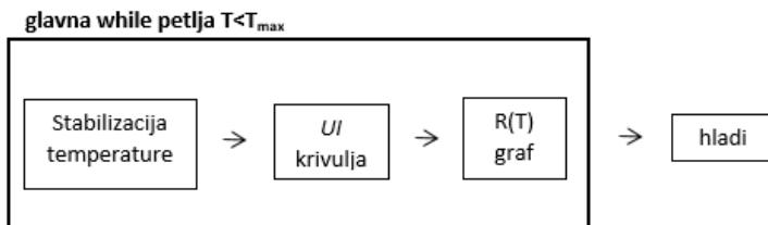
**Slika 1.** Koncept mjerjenja električnog otpora uzorka na temperaturama višima od sobne,  $T_{\text{max}}$  je konačna temperatura mjerjenja
