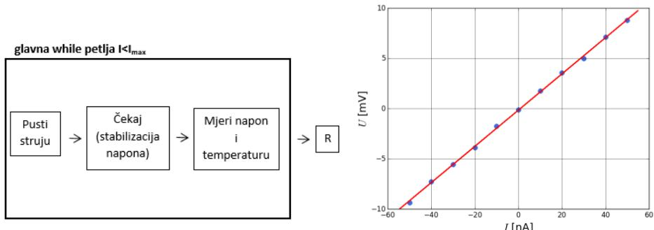
**Slika 4.** Lijevo: dijagram toka za mjerjenje otpora uzorka preko njegove  $UI$  krivulje. Desno: primjer tipične  $UI$  krivulje za kompozitni materijal SU8+grafen na temperaturi 467 K. Izračunati otpor je  $0.18$  k $\Omega$ .
