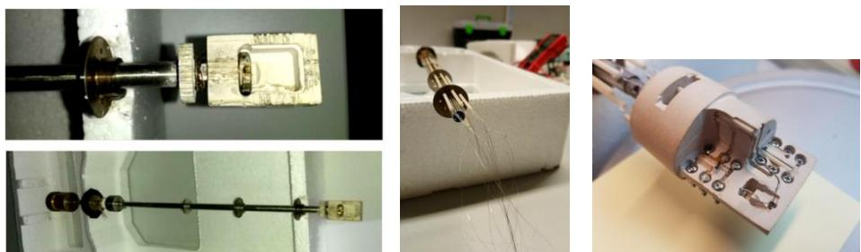
**Slika 5.** Lijevo: ranije korišteni nosač uzorka (dolje) i uvećana glava ranije korištenog nosača uzorka (gore). Sredina: nove keramičke cjevčice kroz koje su provedene platinske žice. Desno: nova glava uzorka s jednim postavljenim uzorkom.
