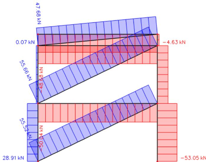
Slika 37 Dijagram uzdužnih sila na bočni spreg
