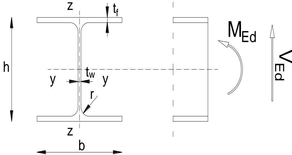
Slika 59 Poprečni presjek zabatnog stupa
