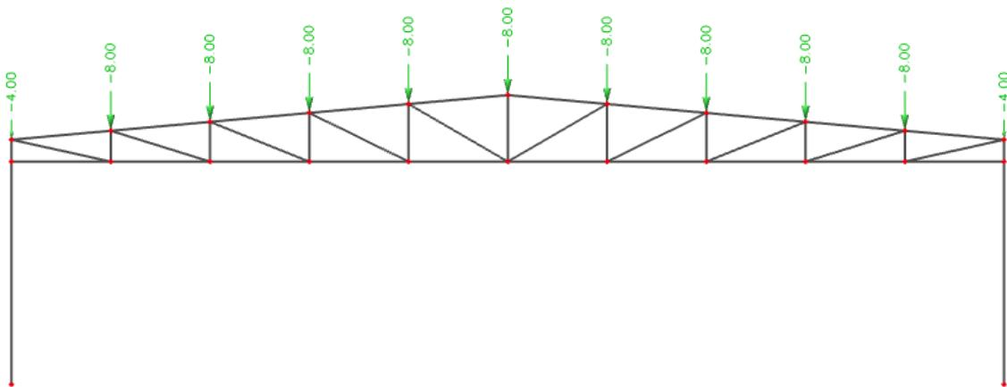
Slika 5 Djelovanje stalnog opterećenja na glavni nosač
