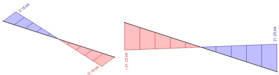
Slika 47 Dijagram poprečnih sila  $V_y$  i  $V_z$  za kombinaciju 4
