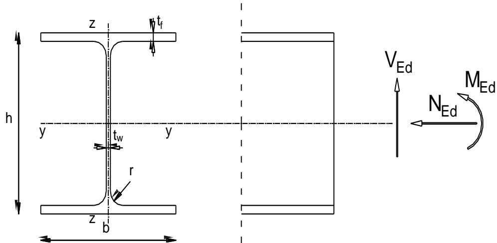
Slika 53 Poprečni presjek stupa
