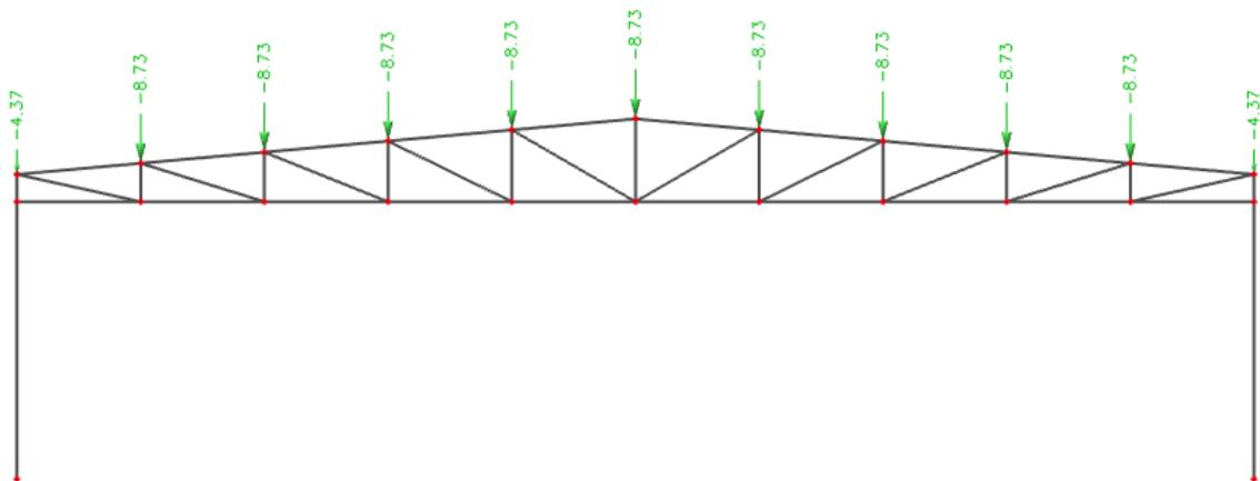
Slika 6 Opterećenje glavnog nosača snijegom
