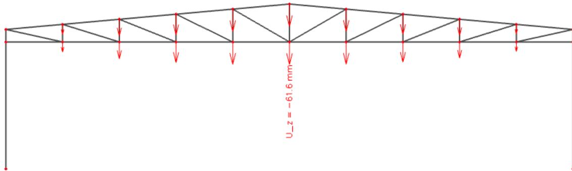
Slika 15 Vertikalni progib glavnog nosača
