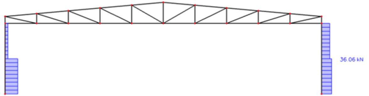
Slika 27 Dijagram poprečnih sila za kombinaciju 4
