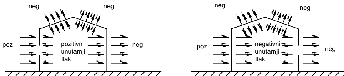
Slika 7 Smjer pozitivnog i negativnog djelovanja vjetra
