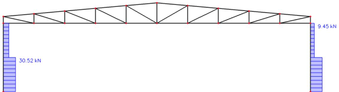
Slika 24 Dijagram poprečnih sila za kombinaciju 3
