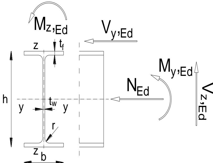
Slika 58 Poprečni presjek krovne podrožnice
