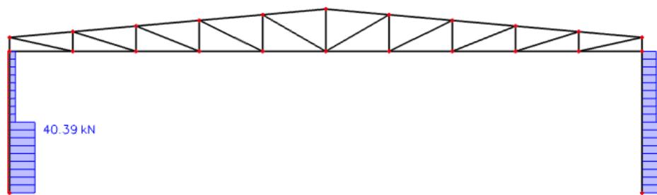
Slika 21 Dijagram poprečnih sila za kombinaciju 2
