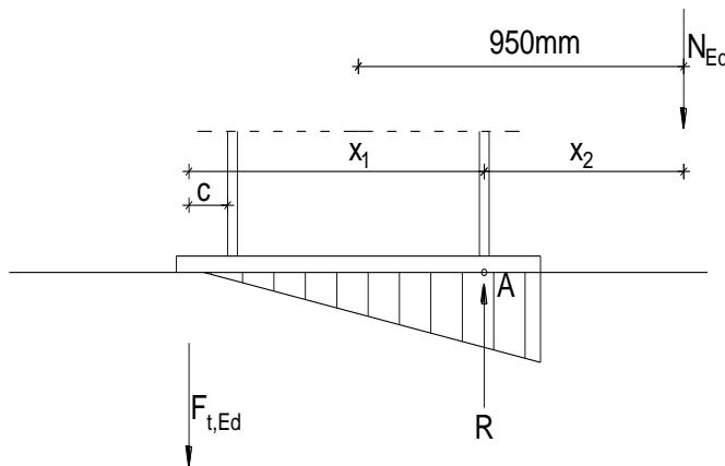
Uz pretpostavku vijaka M-22 udaljenost  $c_{min}$  vijaka od ruba pojasnice iznosi:
