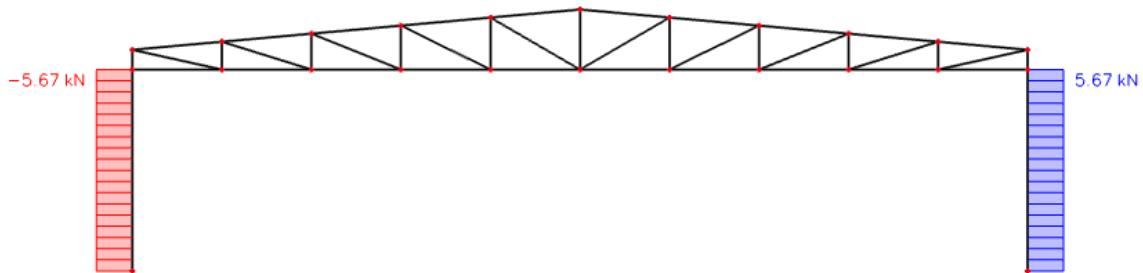
Slika 18 Dijagram poprečnih sila za kombinaciju 1
