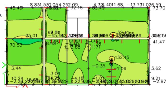
Slika 6.6 Poprečne sile  $V_{Ed,y}$  (kN/m) za GSN-1
