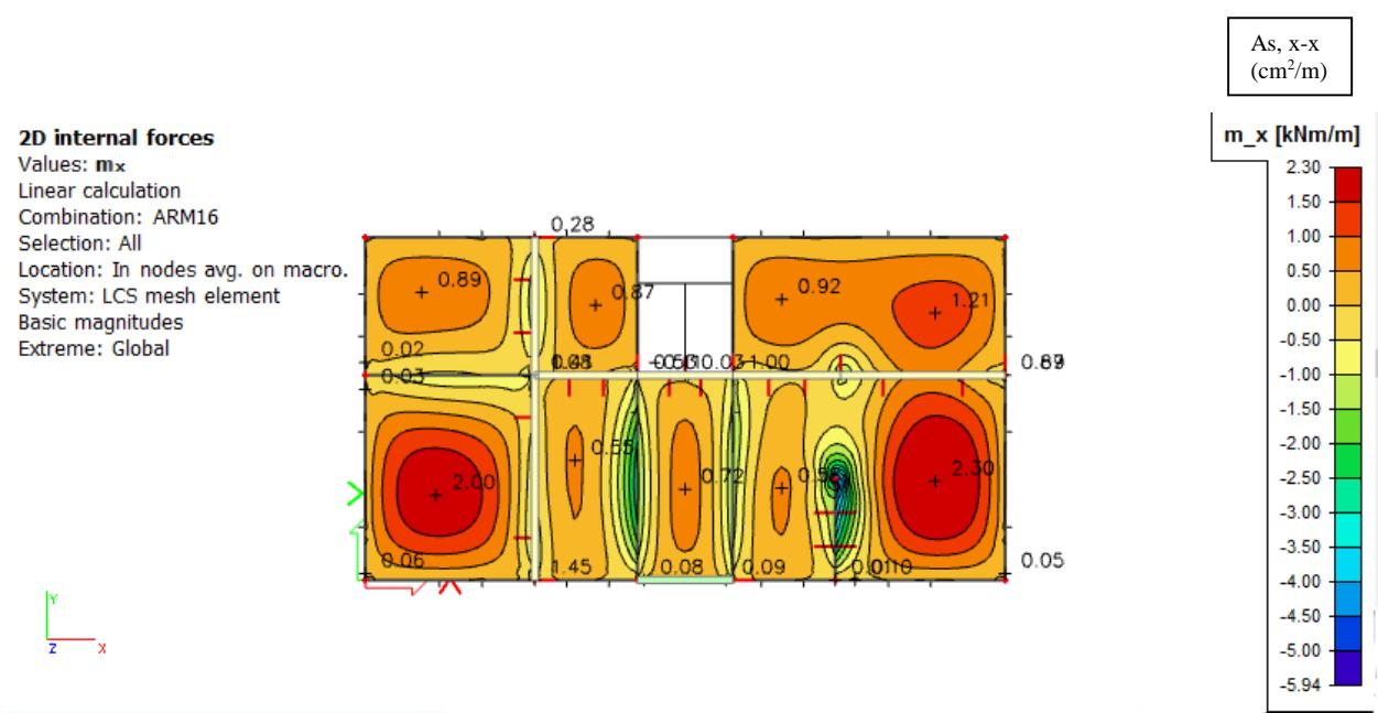
Slika 6.7 Armatura u ploči smjer  $As,x-x$  ( $\text{cm}^2/\text{m}$ ) za GSN-I
