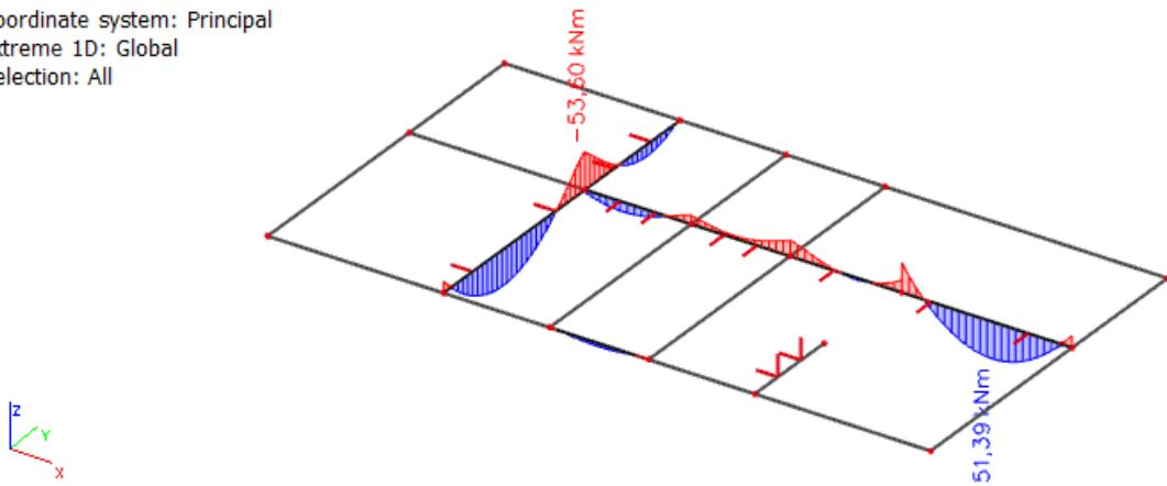
Slika 8.11 Moment savijanja  $M_{Ed,y}$  (kNm) za GSU-1
