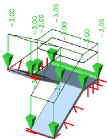
Slika 4.6 Promjenjivo djelovanje  $Q(\text{kN/m}^2)$
