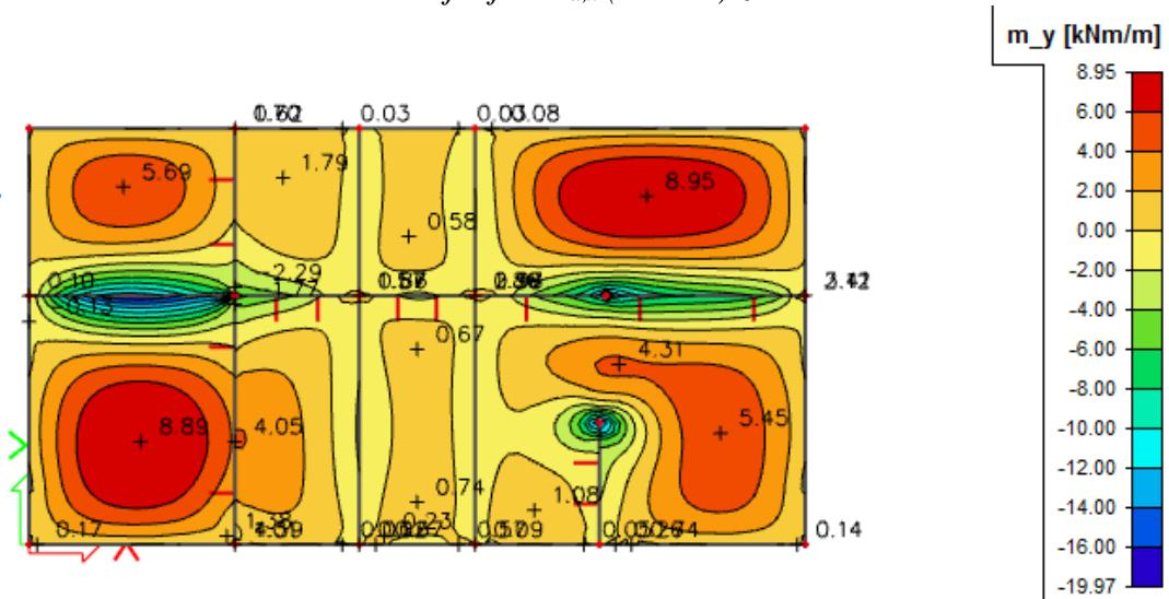
Slika 7.17 Moment savijanja  $M_{Ed,y}$  (kNm/m) za GSU-I
