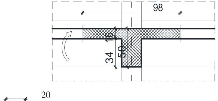
Slika 8.3 Poprečni presjek grede (polje1)
