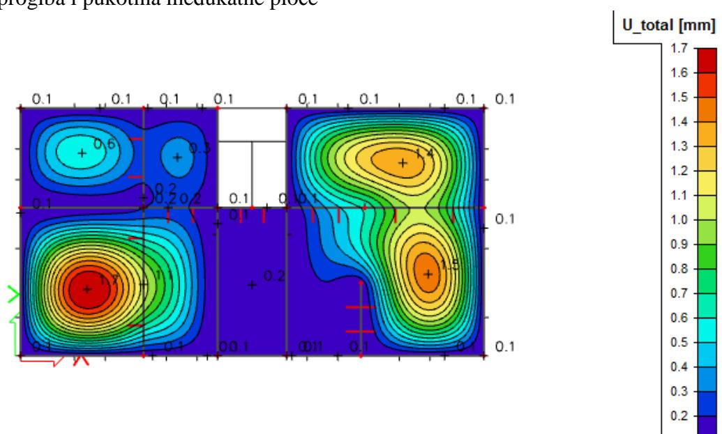
Slika 6.23 Progib ploče (mm) za kombinaciju GSU-1
