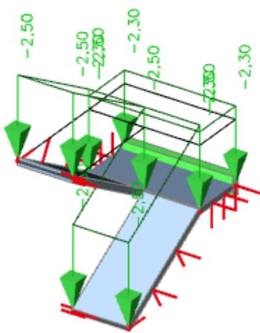
Slika 4.5 Dodatno stalno djelovanje  $G_1(\text{kN/m}^2)$
