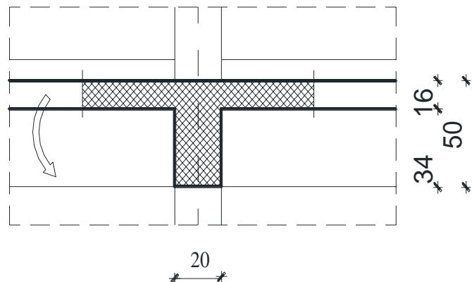
Slika 8.5 Poprečni presjek grede (ležaj)
