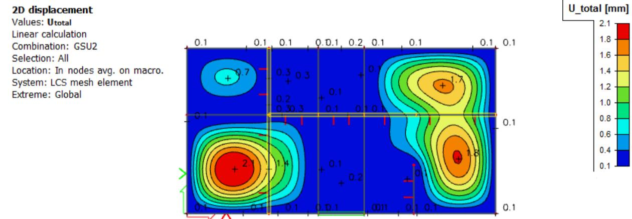
Slika 7.15 Progib ploče (mm) za kombinaciju GSU-2
