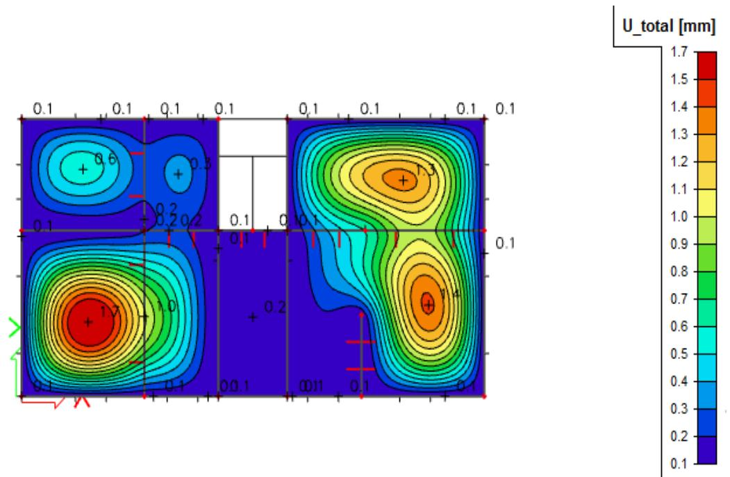
Slika 6.24 Progib ploče (mm) za kombinaciju GSU-2
