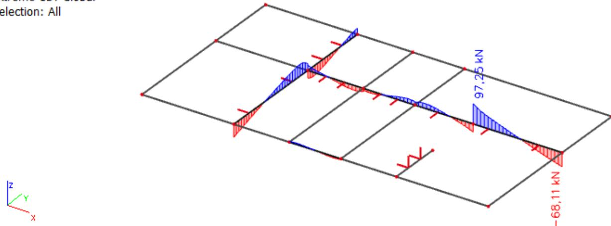
Slika 8.9 Poprečne sile  $V_{Ed,z}$  (kN) za GSN-I
