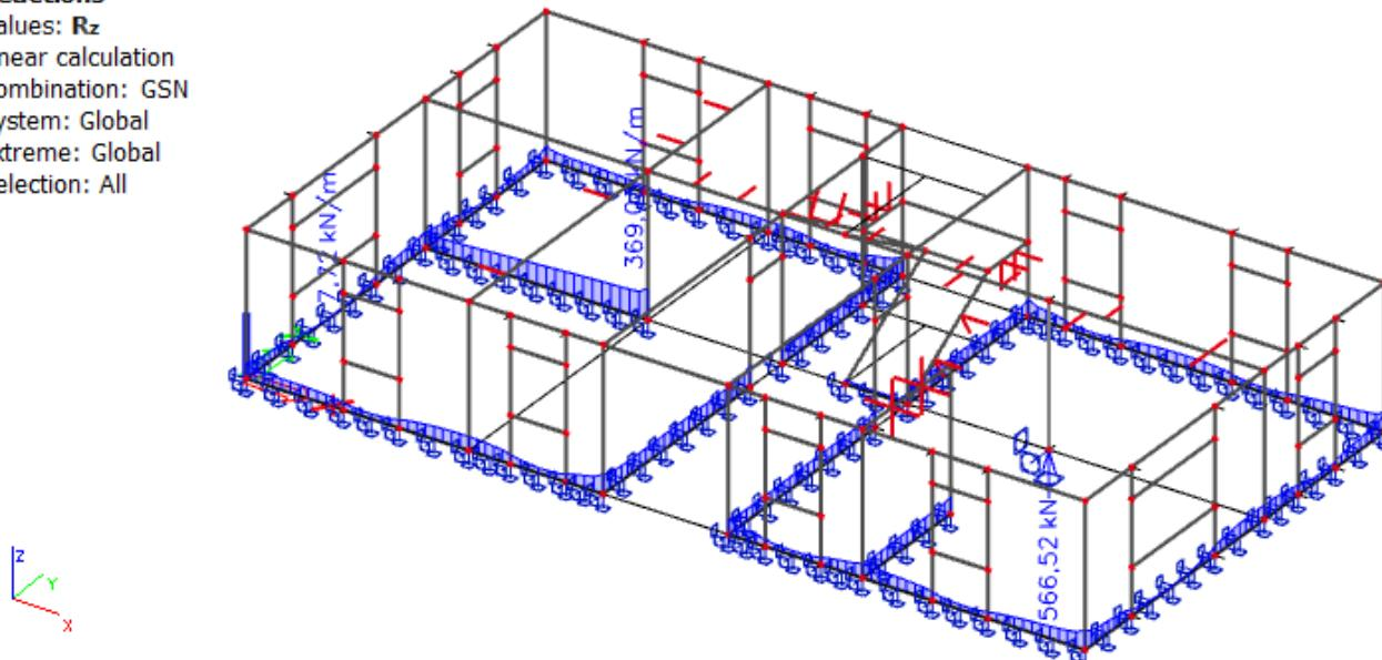
Slika 10.1 Linijske reakcije na mjestima oslanjanja zidova na temeljne trake [kN/m] za kombinaciju GSN-I
