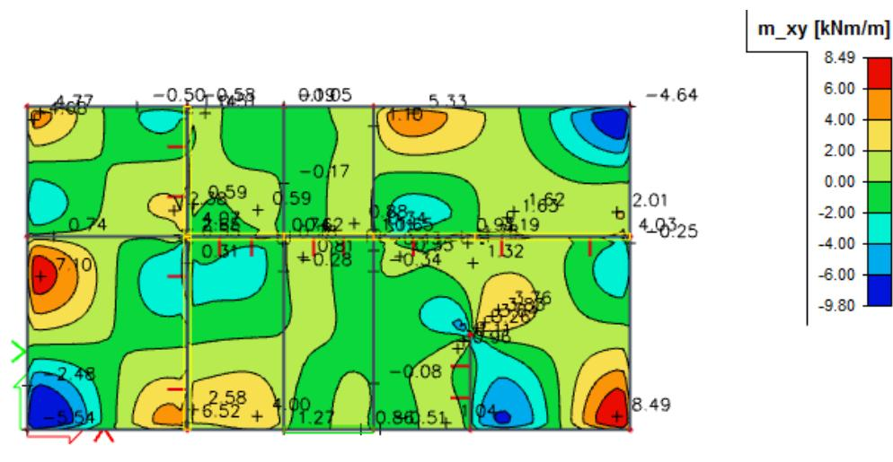
Slika 7.6 Moment savijanja  $M_{Ed,xy}$  (kNm/m) za GSN-1
