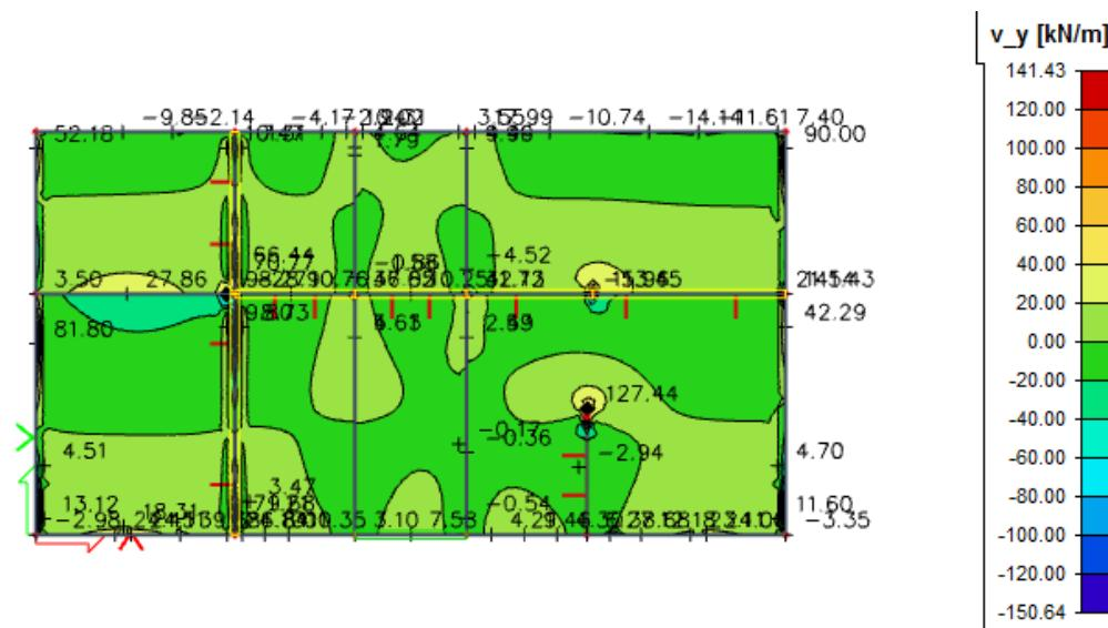
Slika 7.8 Poprečne sile  $V_{Ed,y}$  (kN/m) za GSN-I
