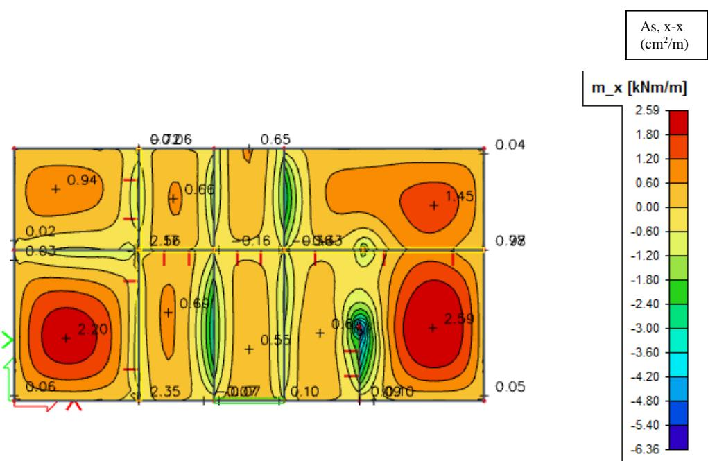
Slika 7.9 Armatura u ploči smjer  $As,x-x$  ( $cm^2/m$ ) za GSN
