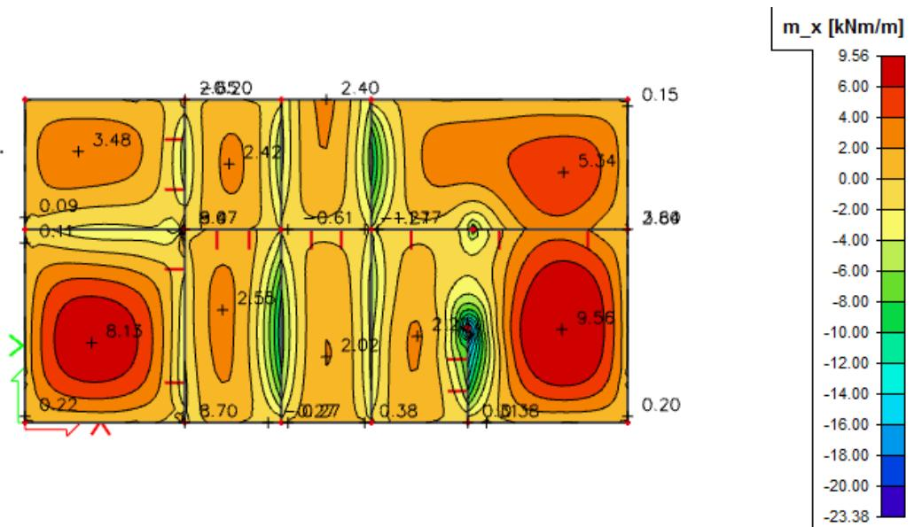
Slika 7.16 Moment savijanja  $M_{Ed,x}$  (kNm/m) za GSU-I
