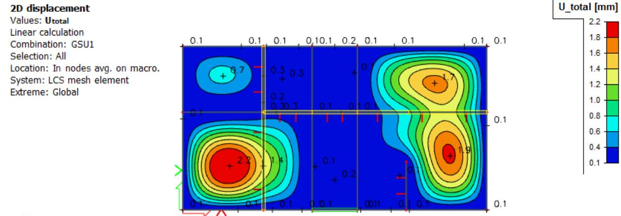
Slika 7.14 Progib ploče (mm) za kombinaciju GSU-1
