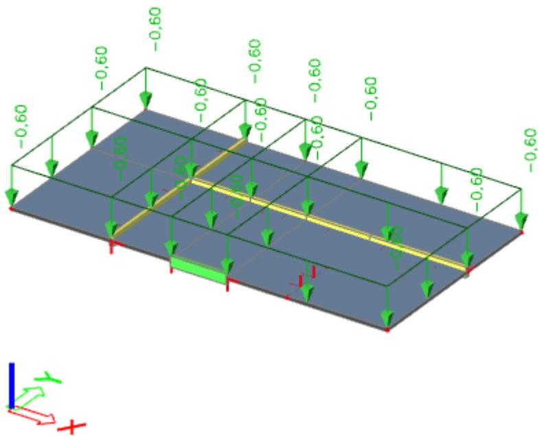
Slika 4.4 Promjenjivo djelovanje  $Q(\text{kN/m}^2)$
