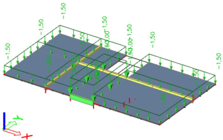
Slika 4.2 Promjenjivo djelovanje  $Q(\text{kN/m}^2)$
