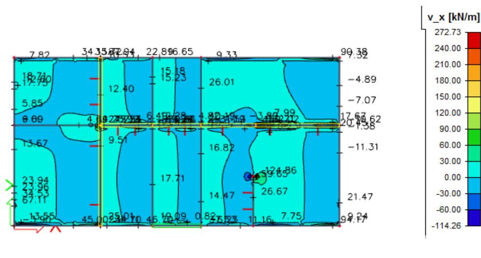
Slika 7.7 Poprečne sile  $V_{Ed,x}$  (kN/m) za GSN-I
