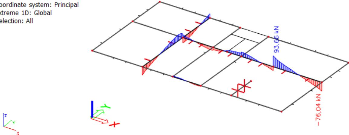
Slika 8.2 Poprečne sile  $V_{Ed,z}$  (kN) za GSN-1
