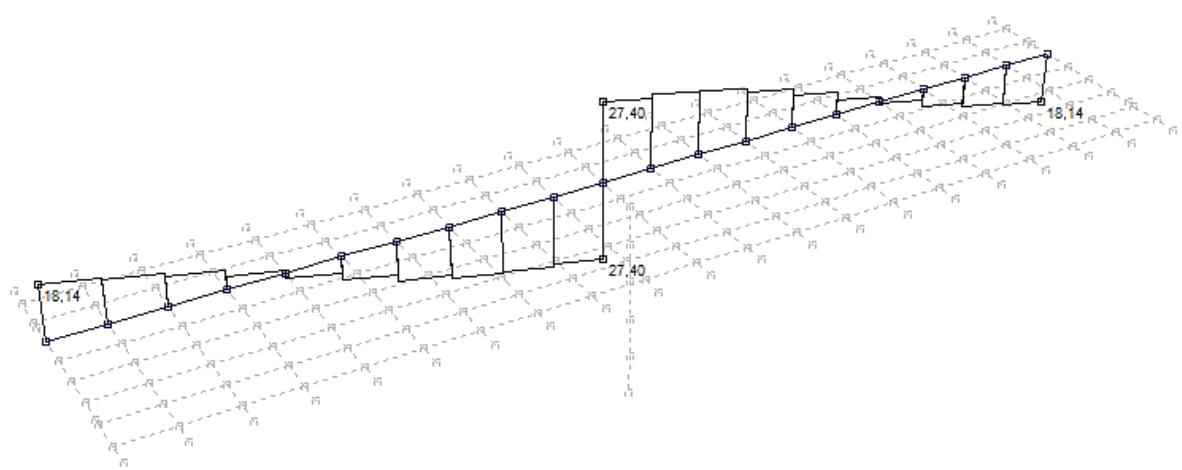
Slika 10: Dodatno stalno opterećenje – Poprečne sile  $T_z$  (kN)
