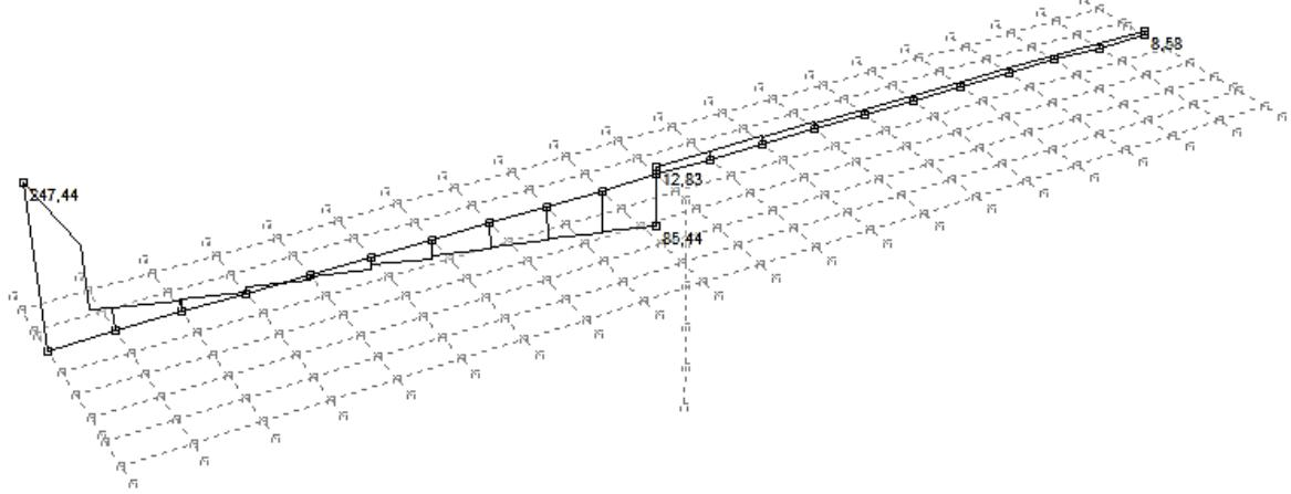
Slika 23: Pokretno opterećenje – maksimalne poprečne sile pri upornjaku – poprečne sile  $T_z$  (kN)
