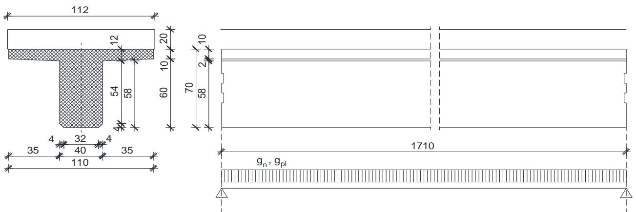
Slika 2: Uzdužna i poprečna dispozicija jednog nosača
