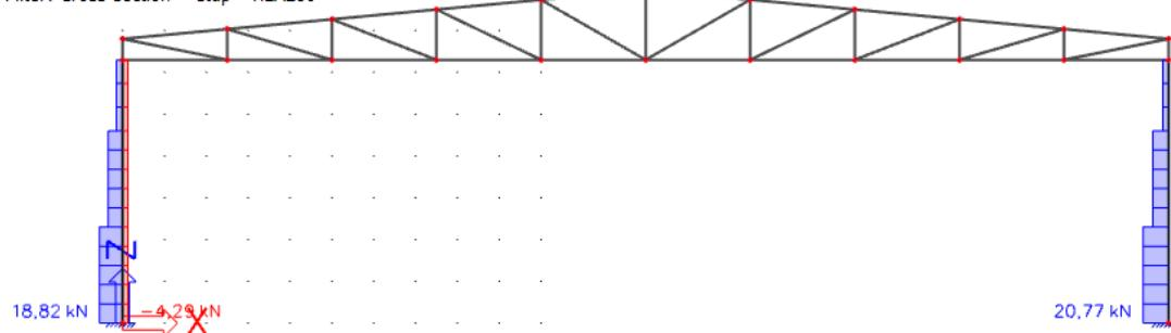
Slika 10 Dijagram poprečnih sila za kombinaciju 3
