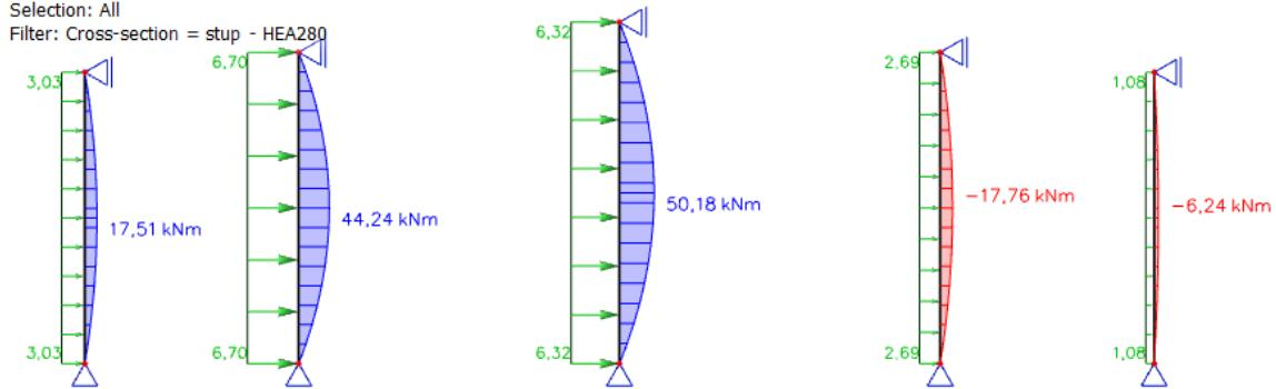
Slika 17 Dijagram momenata na zatvorne stupove od opterećenja W2
