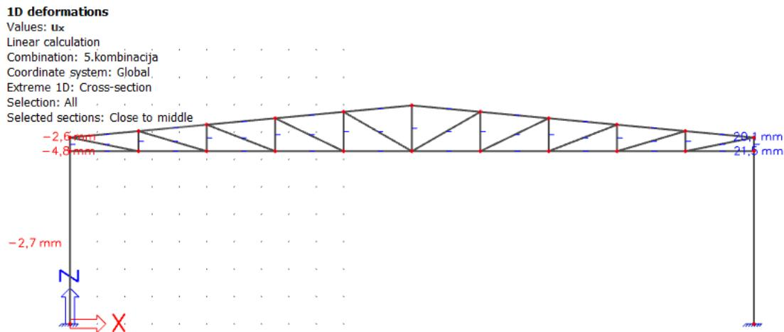
Slika 2 Horizontalni progib glavnog nosača
