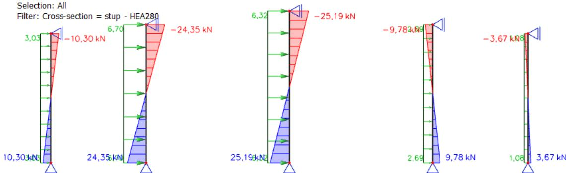
Slika 18 Dijagram poprečnih sila na zatvorne stupove od opterećenja W2
