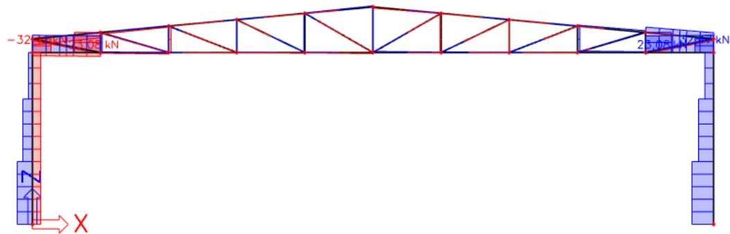
Slika 4 Dijagram poprečnih sila za kombinaciju 1
