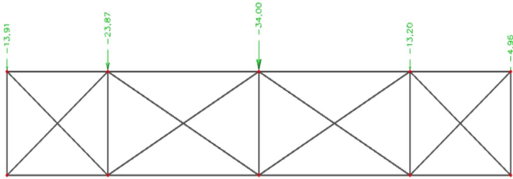
Slika 19 Djelovanje na horizontalni spreg (sa zabatnih stupova) reakcije horizontalnog sprega
