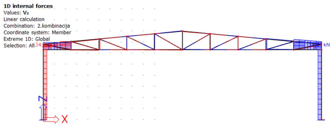
Slika 7 Dijagram poprečnih sila za kombinaciju 2
