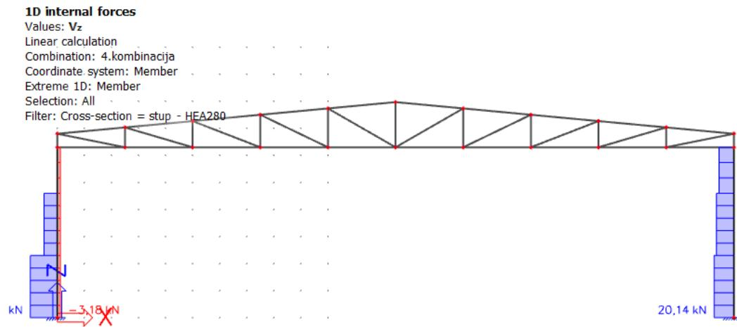
Slika 13 Dijagram poprečnih sila za kombinaciju 4
