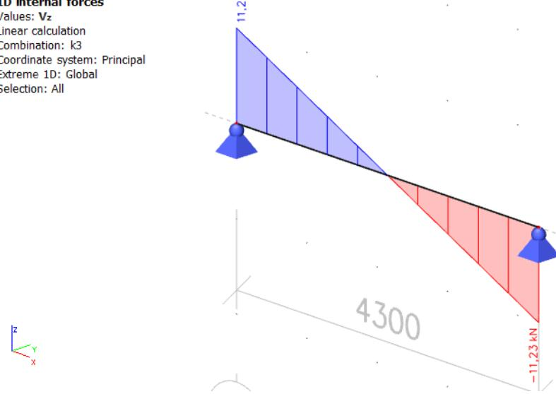
Slika 31 Dijagram poprečnih sila  $V_y$  i  $V_z$  za kombinaciju 3
