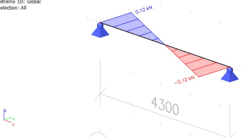
Slika 33 Dijagram poprečnih sila  $V_y$  i  $V_z$  za kombinaciju 4
