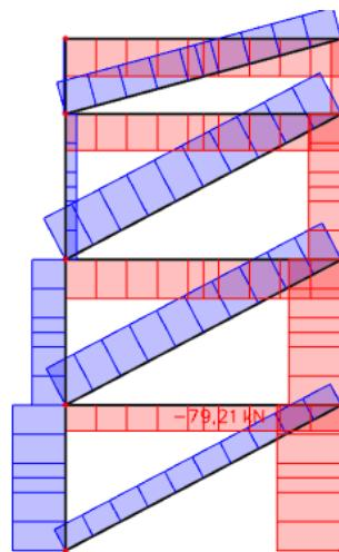
Slika 23 Dijagram uzdužnih sila na bočni spreg
