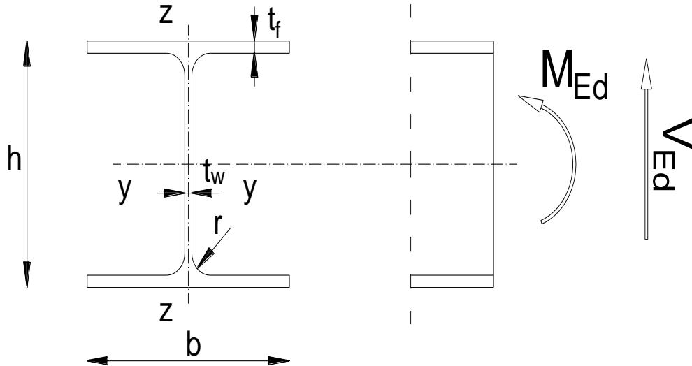
Slika 43 Poprečni presjek zabatnog stupa
