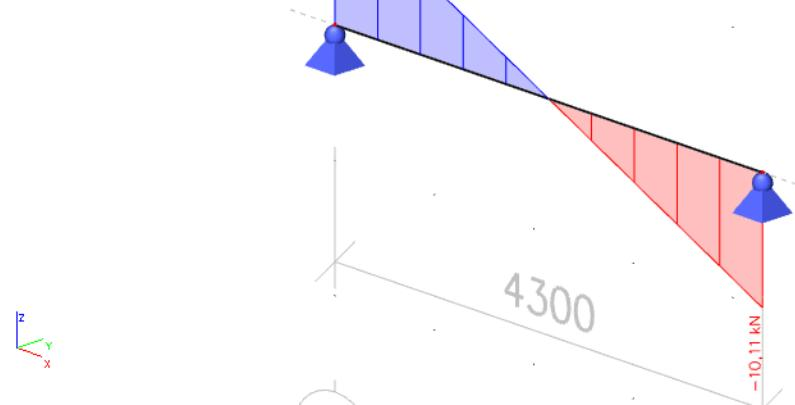
Slika 29 Dijagram poprečnih sila  $V_y$  i  $V_z$  za kombinaciju 2
