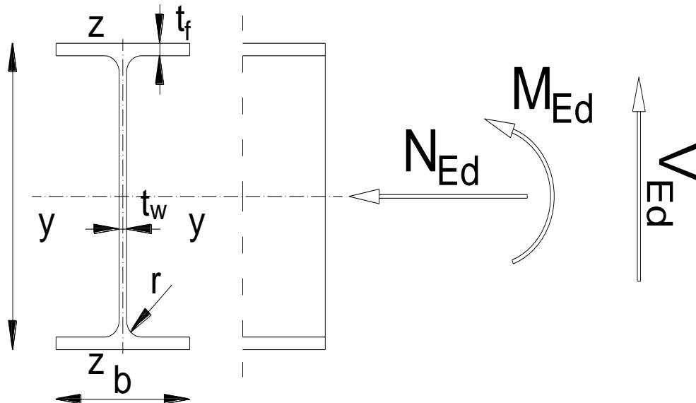
Slika 44 Poprečni presjek bočne podrožnice
