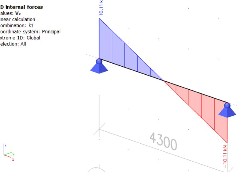
Slika 27 Dijagram poprečnih sila  $V_y$  i  $V_z$  za kombinaciju 1
