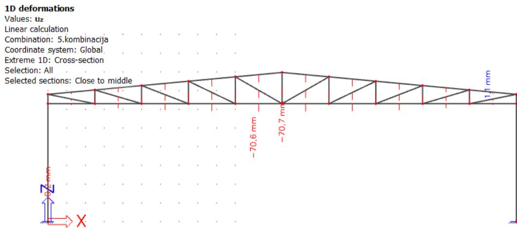
Slika 1 Vertikalni progib glavnog nosača
