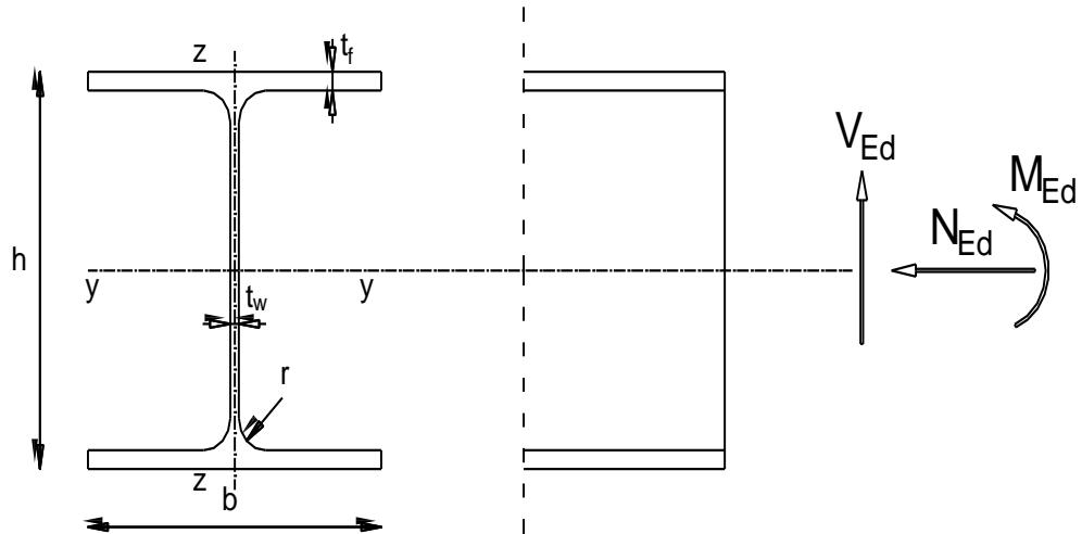
Slika 37 Poprečni presjek stupa
