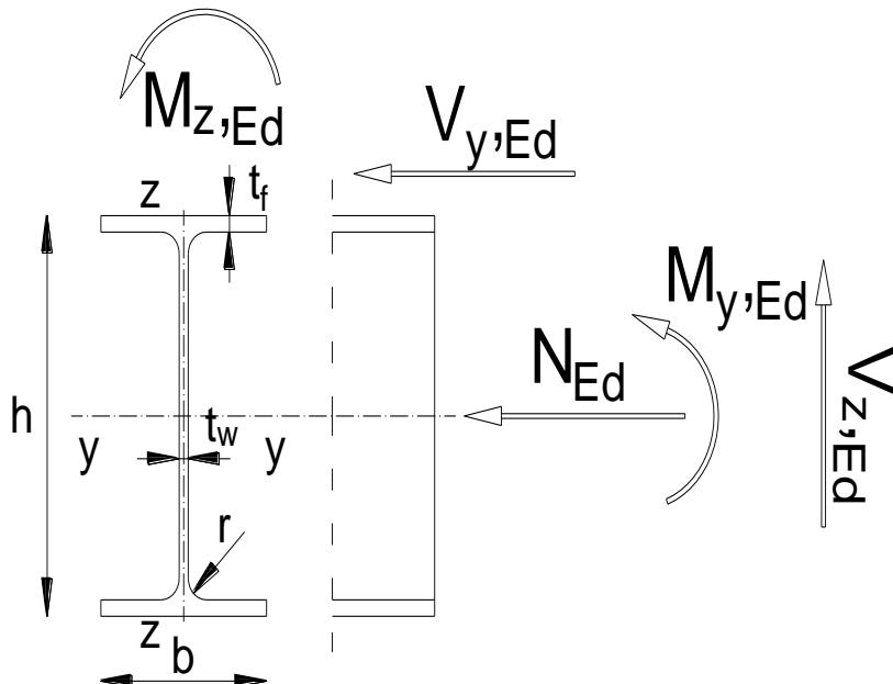
Slika 42 Poprečni presjek krovne podrožnice
