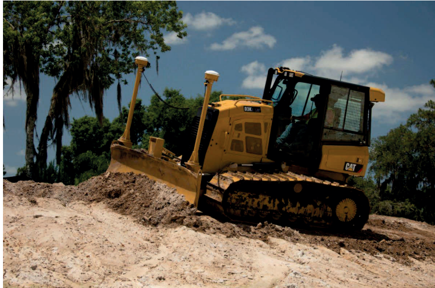
Slika 7. Buldozer CAT D3K2 [7]
