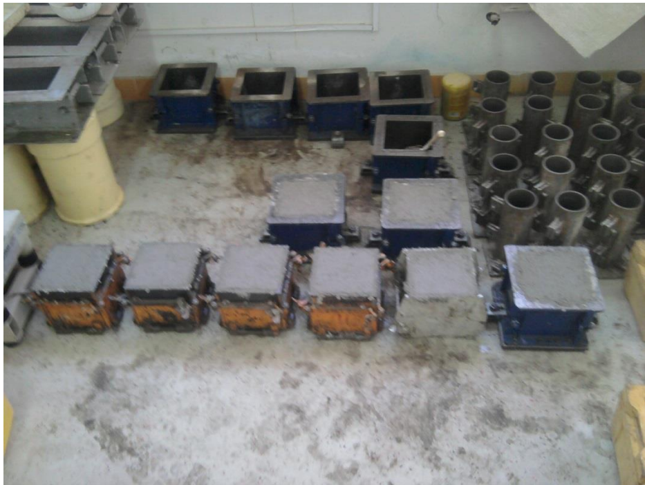
Slika 9.5. Ugrađeni uzorci betona [slika zabilježena tijekom ispitivanja]
