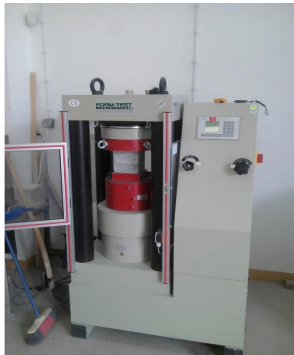
Slika 9.6. Preša za ispitivanje čvrstoće [slika zabilježena tijekom ispitivanja]
