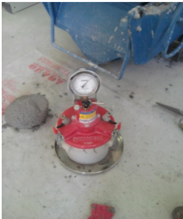
Slika 9.4.Manometar[slika zabilježena tijekom ispitivanja]
