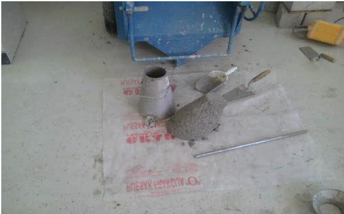
Slika 9.2. Metoda slijeganja [slika zabilježena tijekom ispitivanja]
