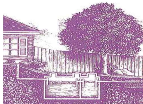
Slika 2.2 Shema dvodjelne septičke jame
