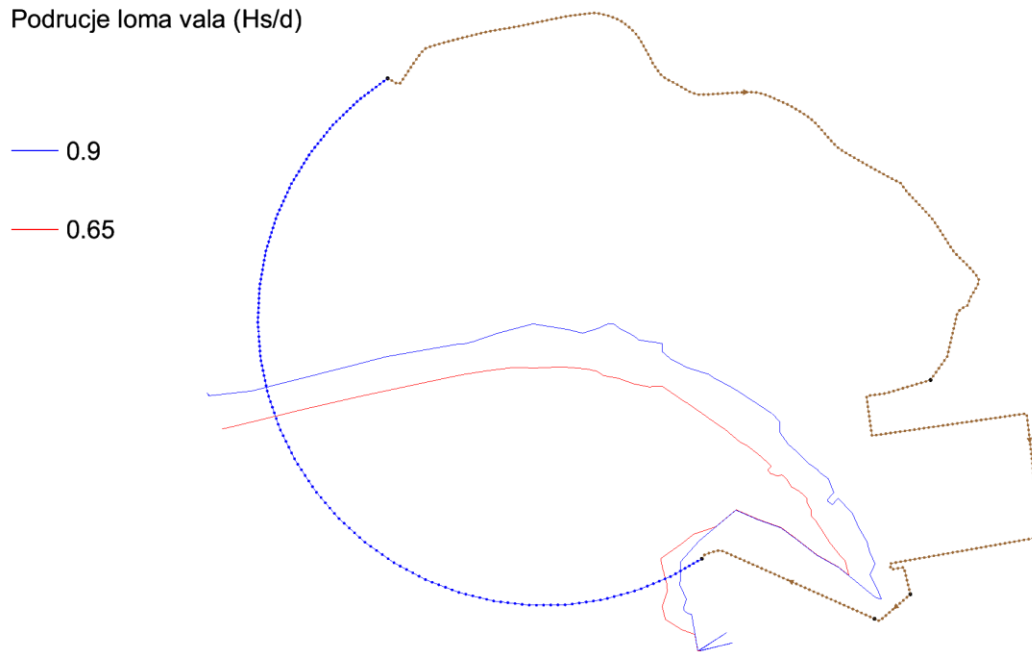
Slika 4.7 Područje loma vala za smjer SW, H^{100}=2,85 m, T^{100}=4,47 s
