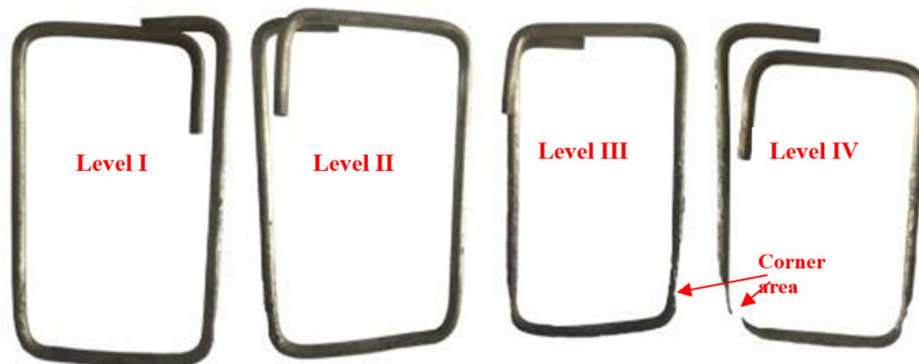
Slika 7.113. Prikaz oštećenja vilica u eksperimentalnim istraživanjima[14]
