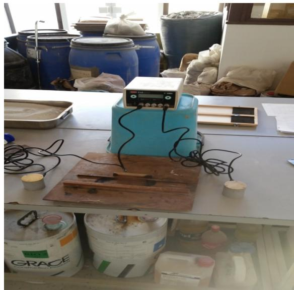
Slika 5.2 Uredaj za mjerjenje ultrazvučnih valova [5]
