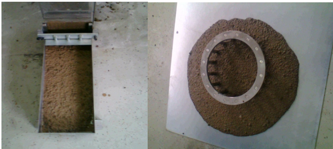
Slika 5.1. Ispitivanje obradivosti u L-box i J-ring [10, 11]
