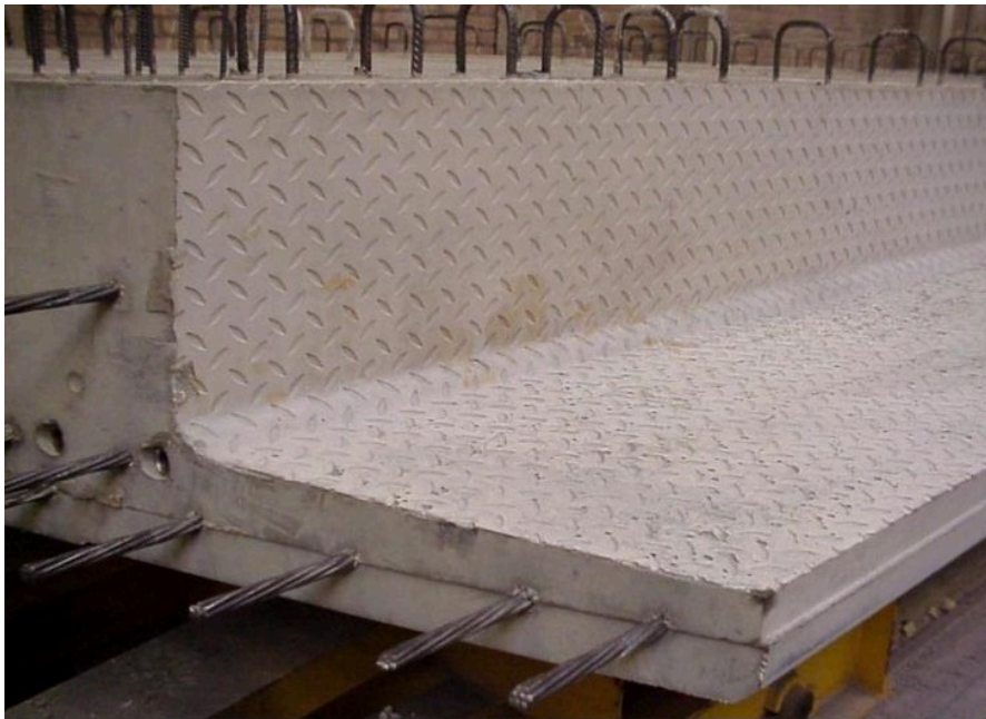
Slika 2.1. Predgotovljeni element od samozbijajućeg betona [8]
