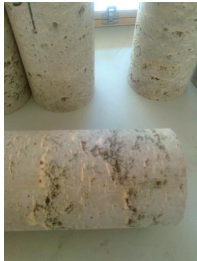
*Slika 5.6. Segregacija betona prilikom ugradnje [slike iz laboratorija]*
