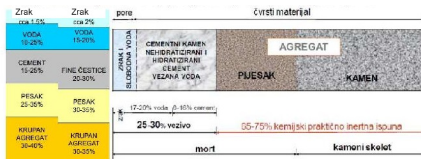
Slika 2.2. Omjer zastupljenosti sastojaka samozbijajućeg betona [9]
