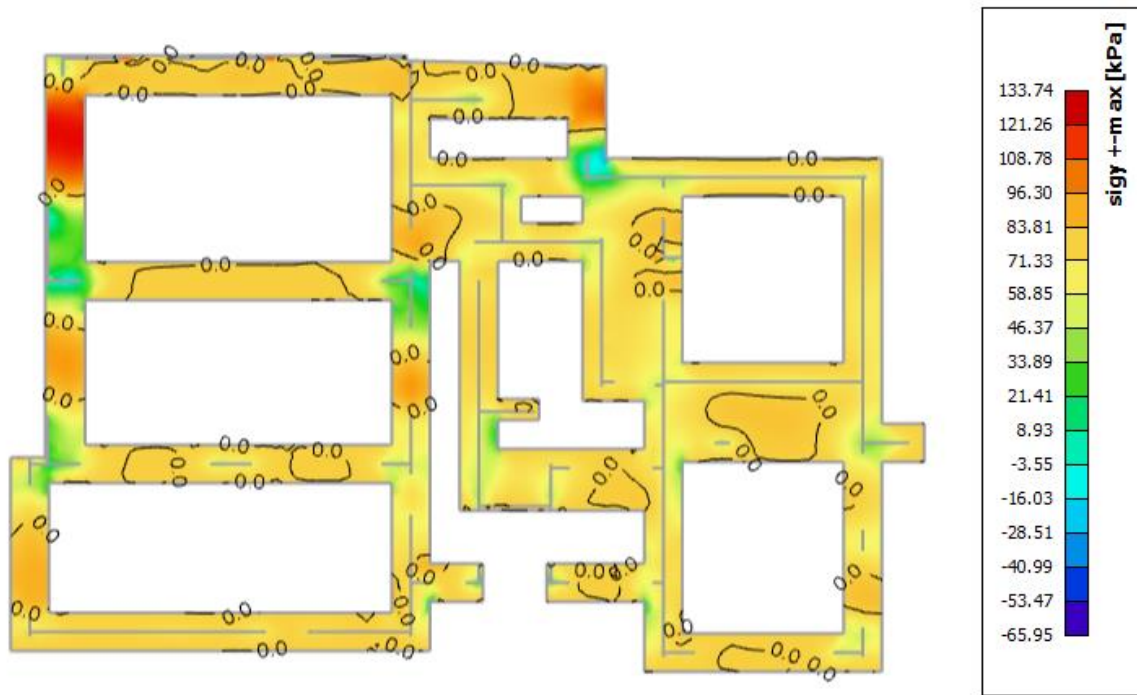
Slika 9.3 Prikaz naprezanja temeljnih traka \sigma_y (kPa) od seizmičke kombinacije
