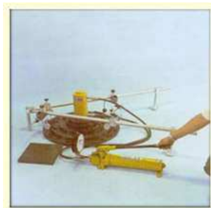
Slika 5.6 Oprema za ispitivanje probnom pločom
