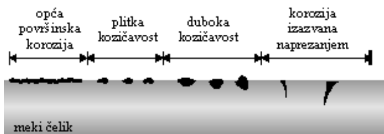
Slika 7.144 Vrste korozije na čeličnoj šipci
