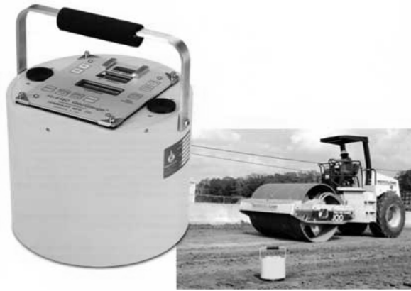
Slika 11.91 Elektronska zamjena za probnu ploču
