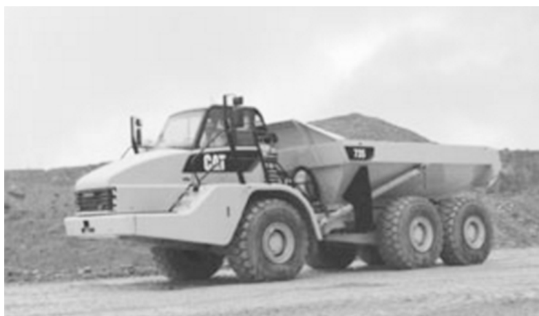
Slika 10.8 Namjensko vozilo za prijevoz i grubo razastiranje
