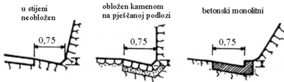
Slika 13.6 Rigoli u nožici pokosa usjeka ili zasjeka
