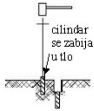
Slika 11.93 Uzimanje uzorka cilindrom iz nasipa
