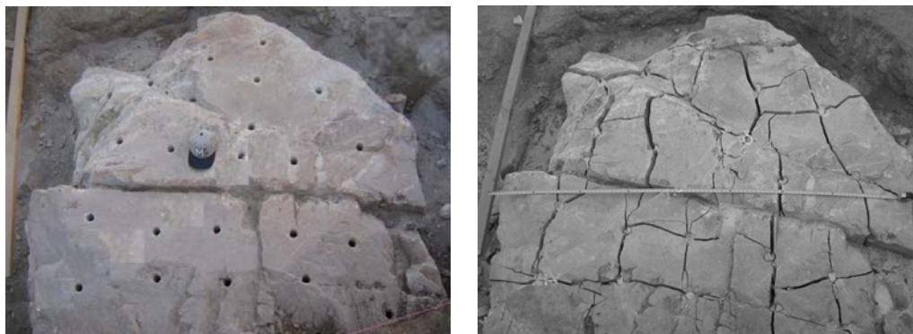
Slika 9.1 Rezultat neeksplozivnog razaranja stijene (Dexpan)
