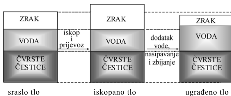
Slika 8.1 Promjena zapremine i količine vode kod zemljanih radova
