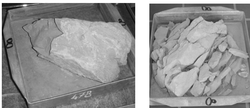
Slika 11.69 Komad svježe iskopanog lapora lijevo i isti komad nakon nekoliko ciklusa sušenja i vlaženja (geotehnički laboratorij Fakulteta, Split )
