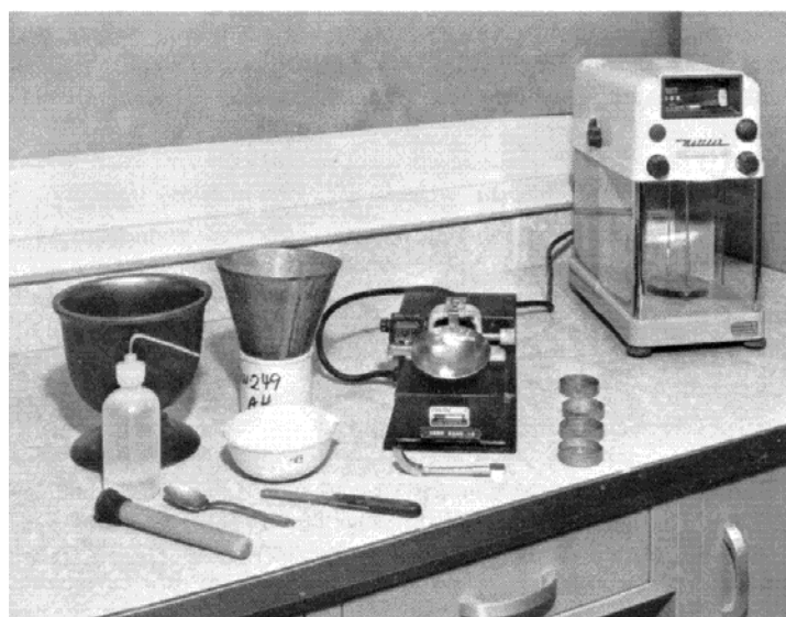
Slika 4.7 Pribor za ispitivanje granice tečenja
