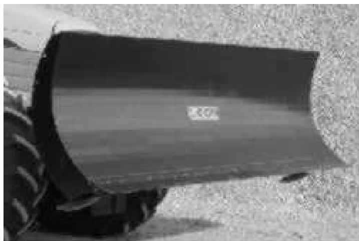
Slika 8.4 Nož (blade) dozera sa sječivom na donjem rubu
