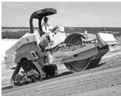
Slika 11.65 Glatki valjak s nožem dozera, za fino planiranje
