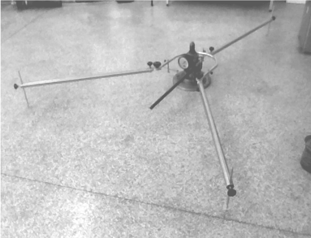
Slika 3.36 Oprema za ispitivanje probnom pločom
