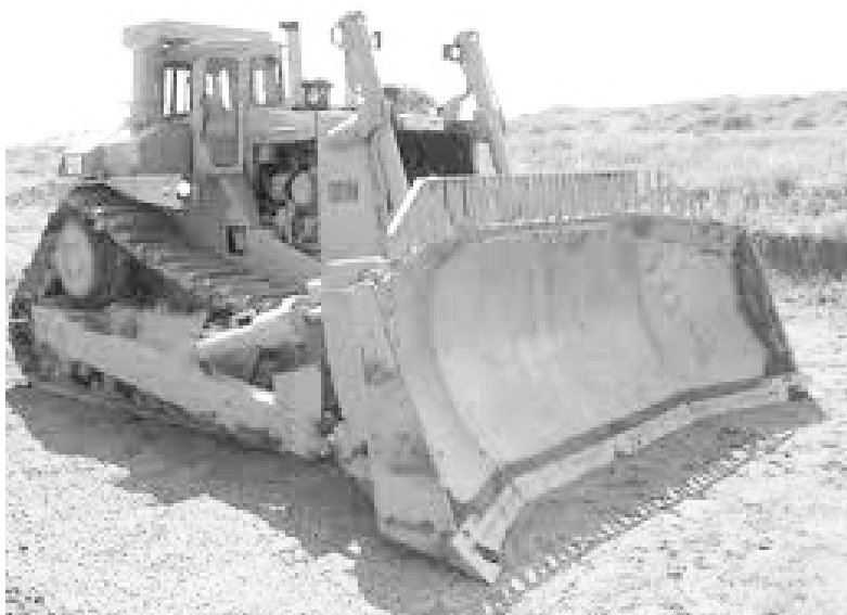
Slika 8.5 Buldozer sa zakrivljenim nožem
