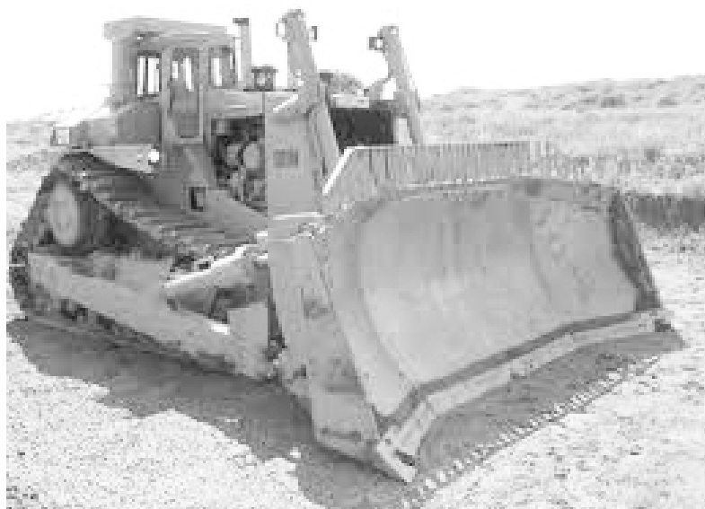
Slika 8.5 Buldozer sa zakrivljenim nožem
