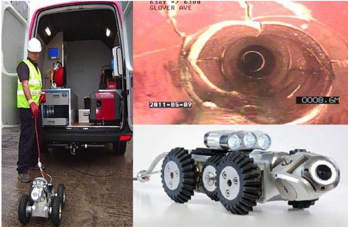
Slika 6. Oprema za unutrašnji pregled pomoću samohodne CCTV kamere [8]
