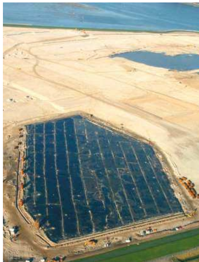
Slika 9.63 Polje podvrgnuto vakuum konsolidaciji
