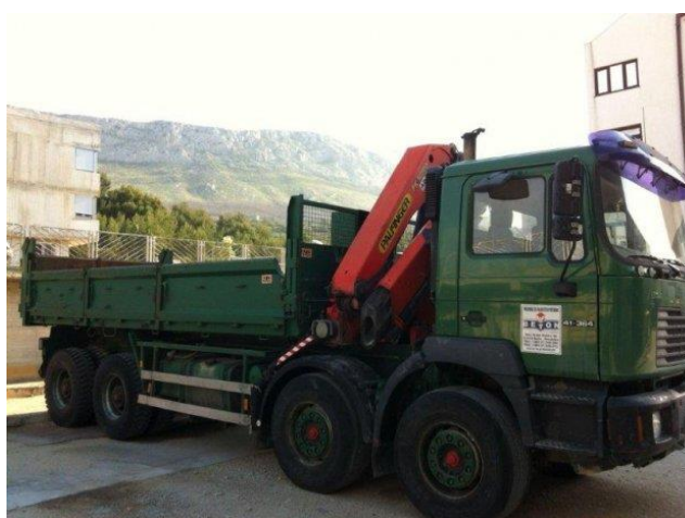
Kamion MAN s kranom F2000 T46 (Slika 1.4.) 3
