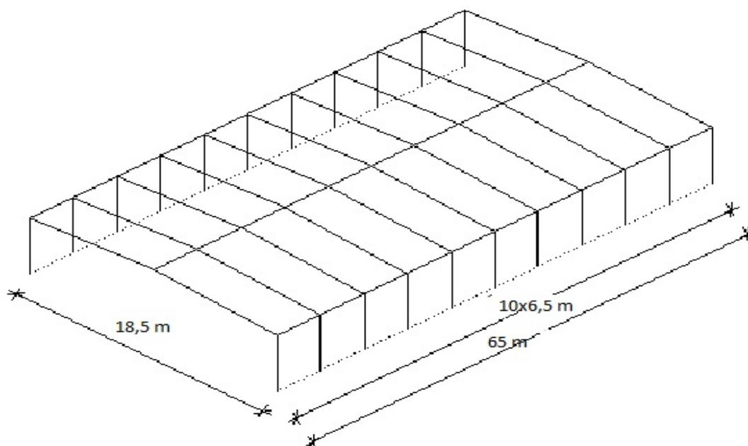
Na grede okvira se oslanjaju sekundarni krovni nosači (podrožnice) na međusobnom osnom razmaku od 2,33 (m), a na stupove su oslonjeni sekundarni bočni nosači na međusobnom osnom razmaku od 2,5 (m).
