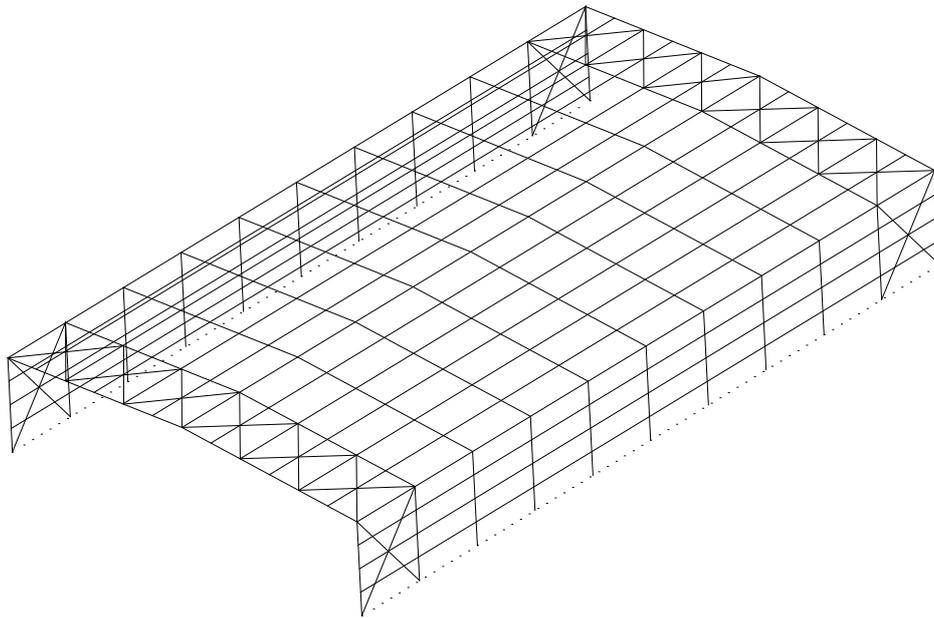
Stupovi i grede su punostijeni nosači međusobno spojeni upetim vezama zbog zahtjeva uporabljivosti same hale. Spoj stupa sa temeljem ostvaren je također upetom vezom.
