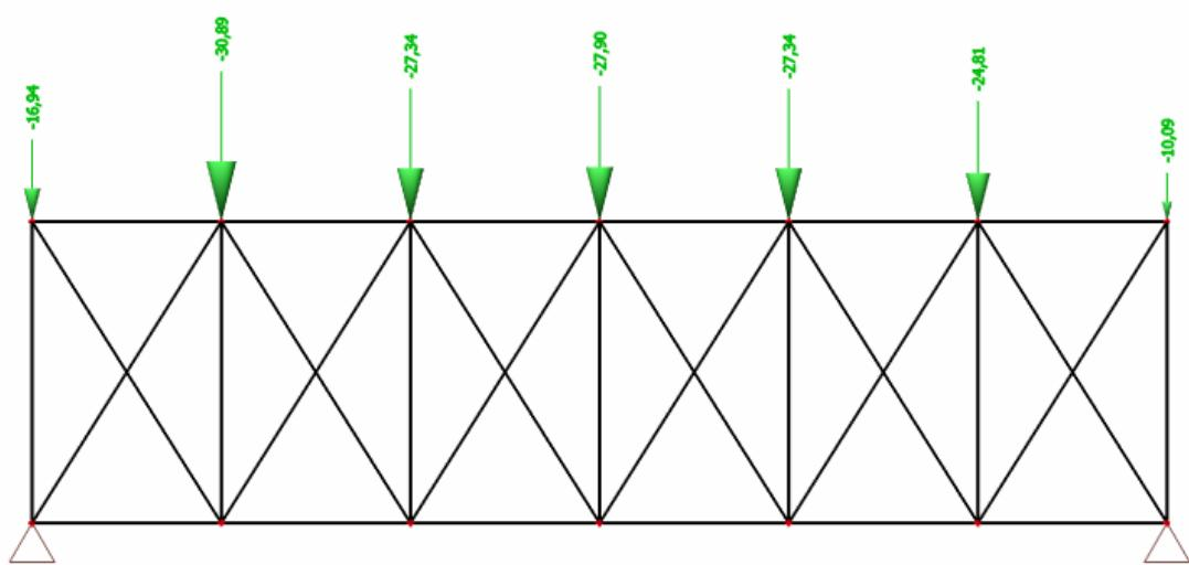
Slika 5.1. Raspored krovnih spregova i opterećenje
