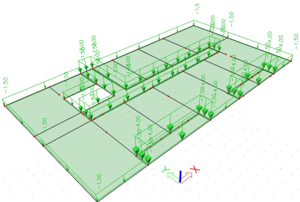
Slika 6.5: Promjenjivo opterećenje  $Q$  [ $\text{kN/m}^2$ ]
