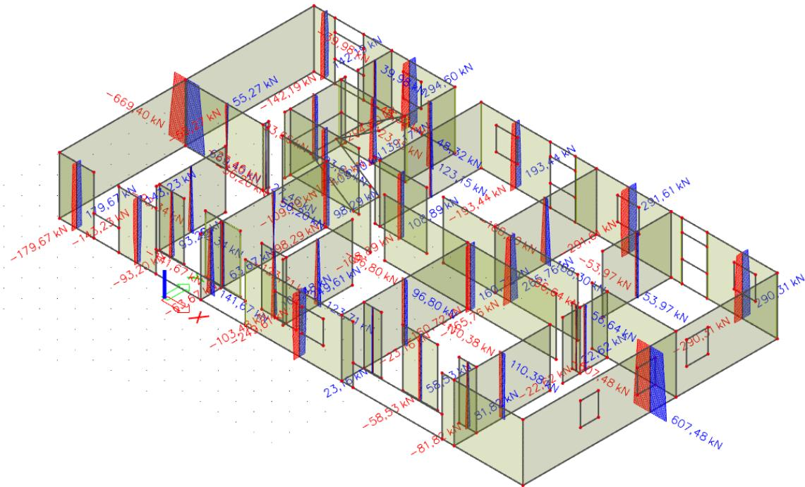
Slika 5.6: Dijagram uzdužnih sila  $N$  [kN] za kombinaciju 1,25 Sx
