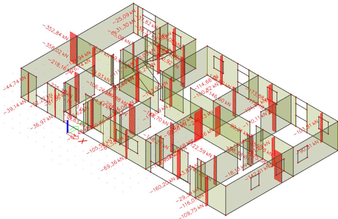
Slika 5.8: Dijagram uzdužnih sila  $N$  [kN] za kombinaciju GSU2
