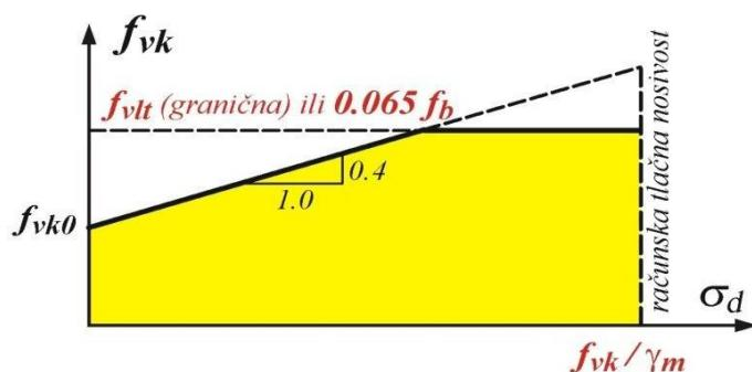
Slika 1.9: Ovisnost posmične čvrstoće i tlačnog naprezanja
