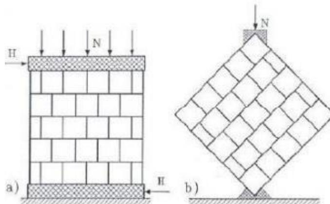
Slika 1.12: Ispitivanje vlačne čvrstoće zida
