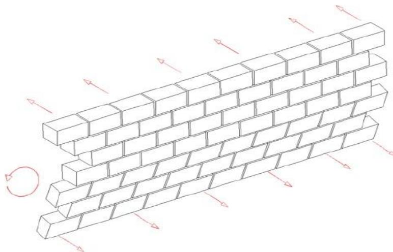
Slika 1.13: Ravnina otkazivanja paralelna horizontalnim sljubnicama,  $f_{xk1}$
