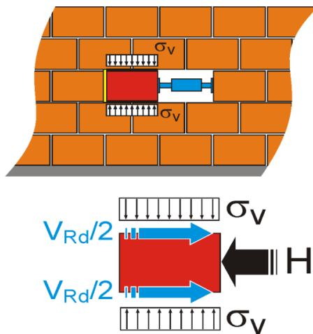
Slika 1.11: Ispitivanje posmične čvrstoće zida – in situ
