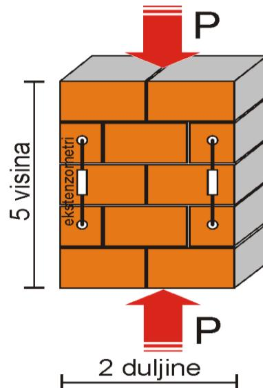
Slika 1.8: Ispitanje tlačne čvrstoće zida
