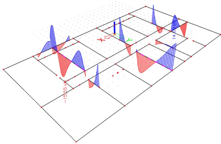
Slika 6.13: Poprečne sile  $VSd,z$  [kN] na gredama za osnovnu kombinaciju GSN-I=1,35G +1,50Q1
