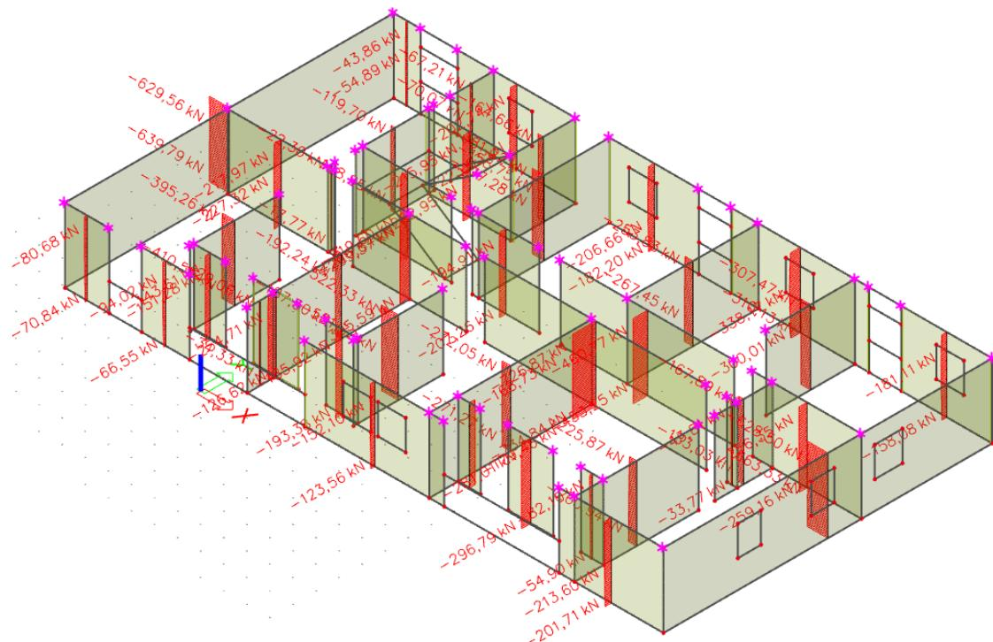
Slika 5.1: Dijagram uzdužnih sila  $N$  [kN] za opterećenje GSN
