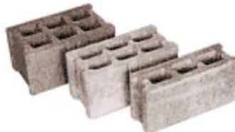
*Slika 1.3: Betonski blok*
