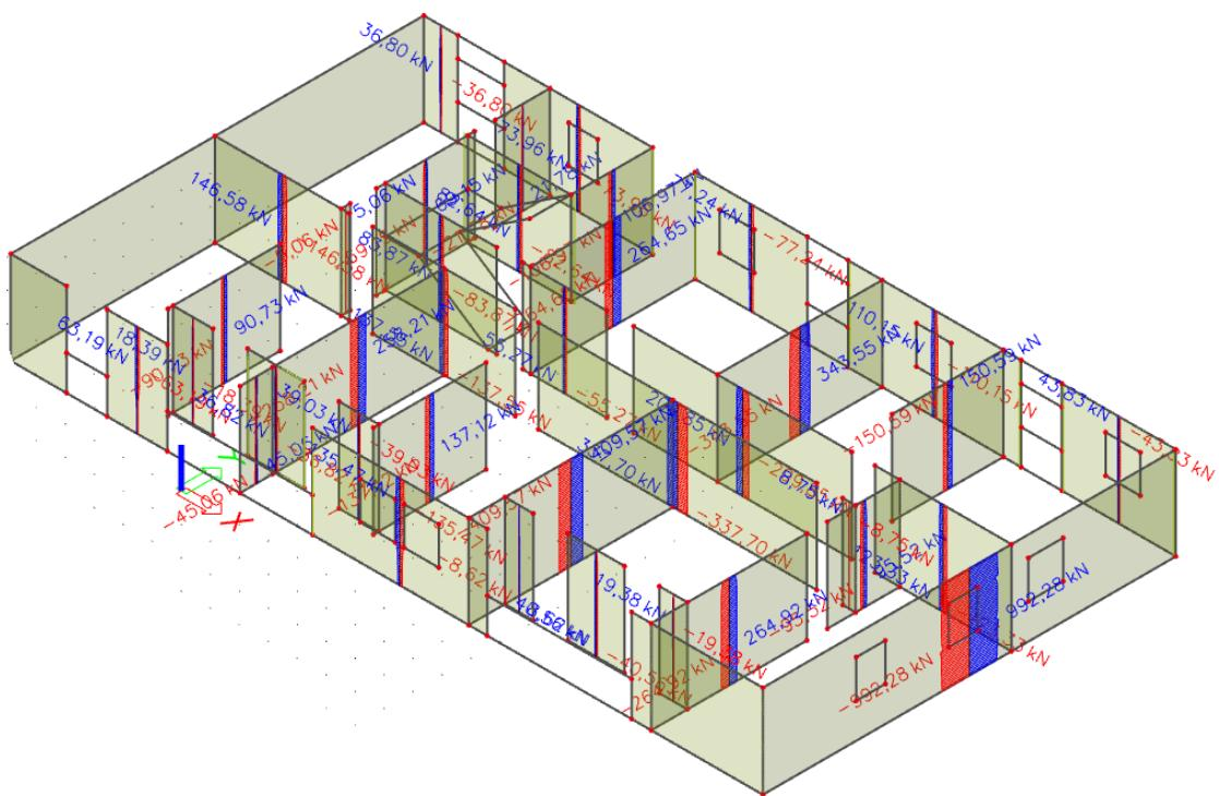
Slika 5.5: Dijagram poprečnih sila  $V$  [kN] za kombinaciju 1,25 Sx
