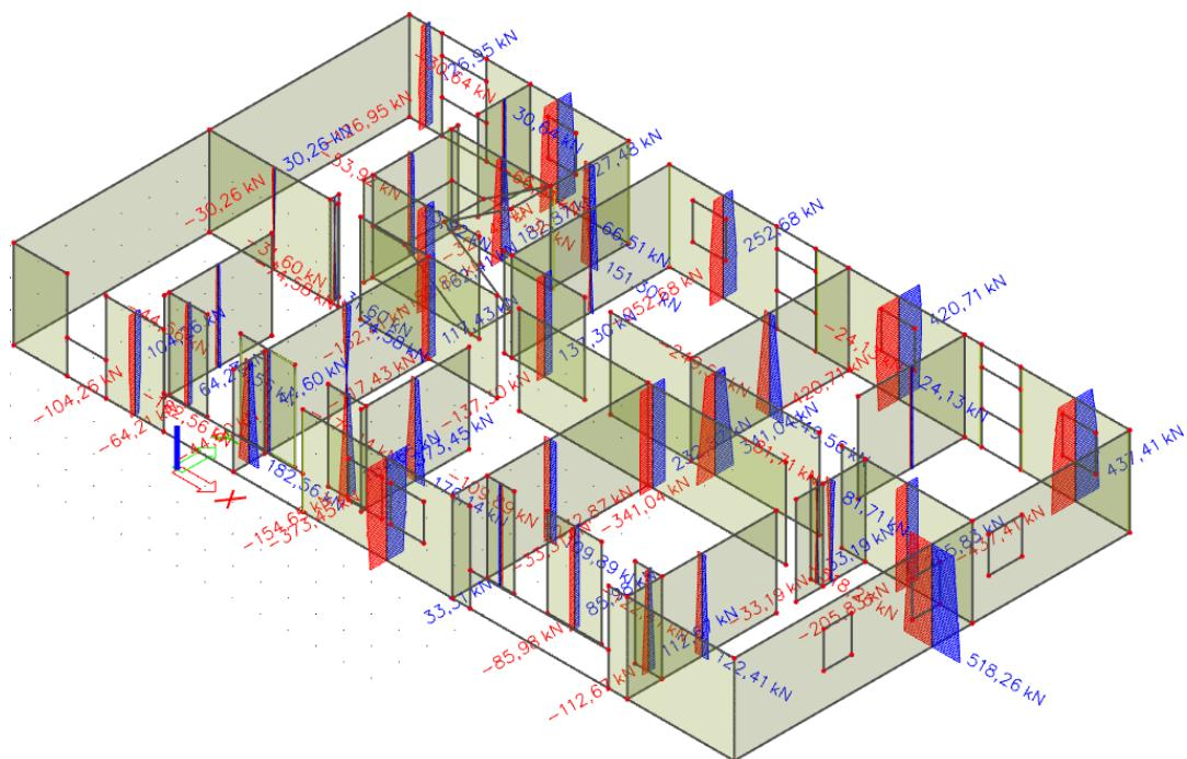
Slika 5.7: Dijagram uzdužnih sila  $N$  [kN] za kombinaciju 1,32 Sy
