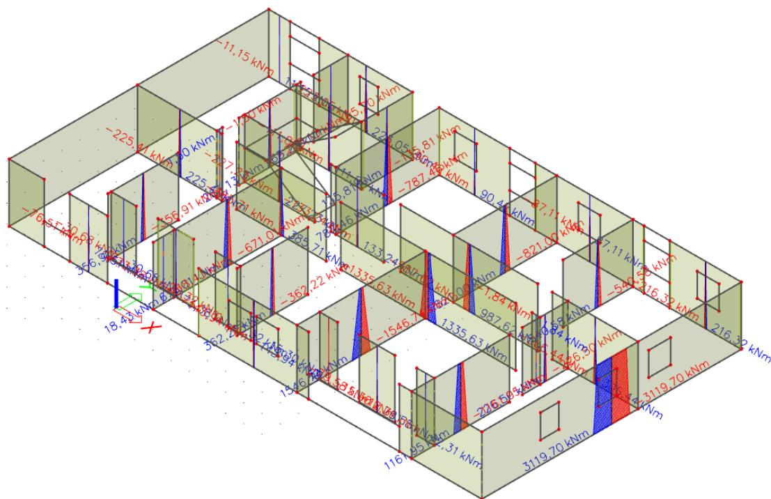
Slika 5.3: Dijagram momenata  $M$  [ $\text{kN}/\text{m}$ ] za kombinaciju 1,32Sy
