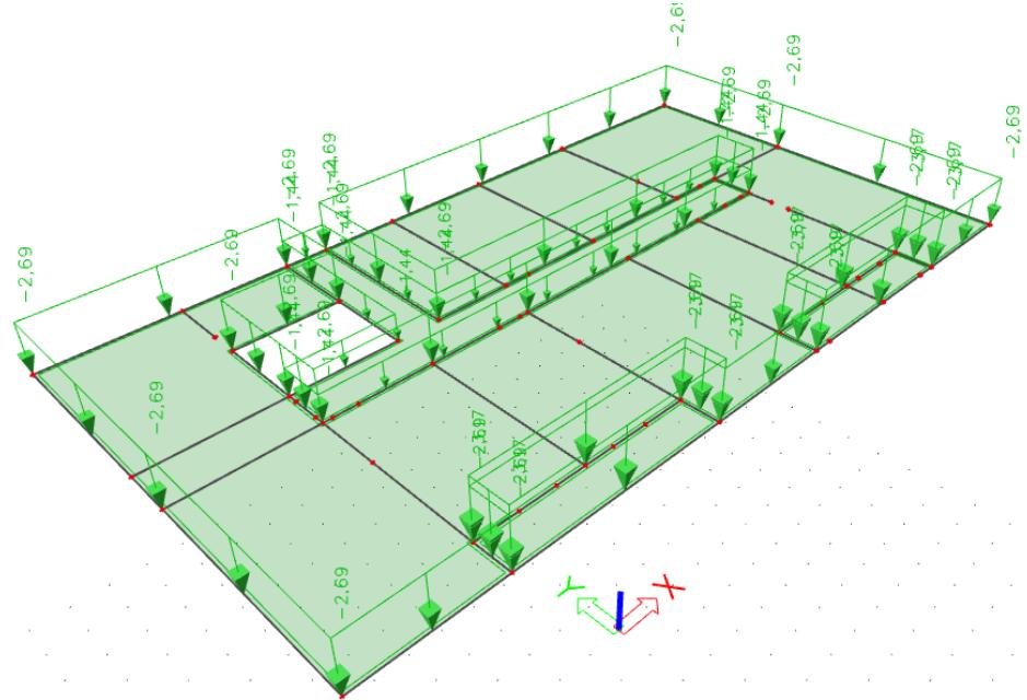
Slika 6.4: Stalno opterećenje  $G$  [ $\text{kN/m}^2$ ]
